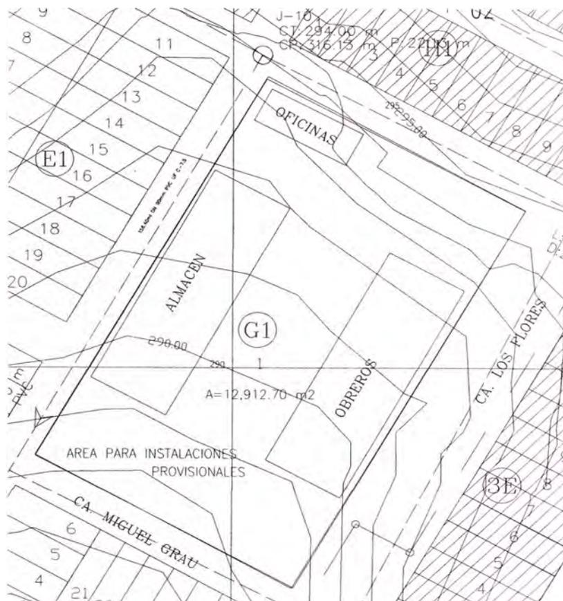
Figura 2.2: Infraestructura provisional del proyecto Abastecimiento de Agua Potable del C.P.M. Augusto B. Leguía Nuevo Imperial-Cañete, Fuente: Elaboración propia.
