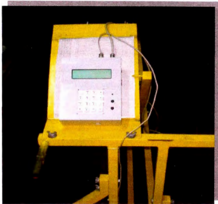
Figura 4.1: Automatización del Rugosímetro MERLIN (Fuente: IIFIC )
