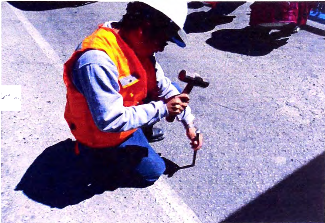
Imagen No 2: Se aprecia la manera de obtener una muestra para medir el espesor de la capa de rodadura Km 114+500
