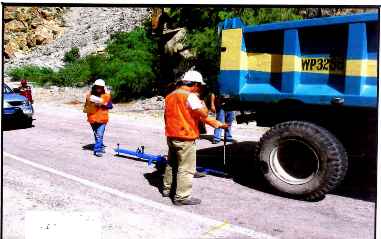
En la imagen se aprecia el la colocación de la Viga Benkelman entre las ruedas del eje posterior del camión para el inicio del ensayo.
