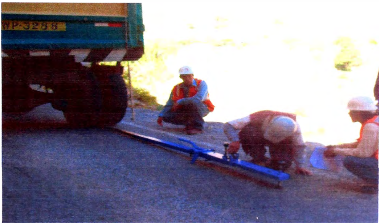
FOTO 2: Calibración del dial de la Viga Benkelman, previo a realizar las mediciones de deflexiones.
