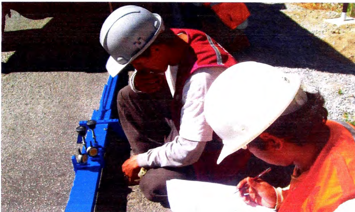
FOTO 3: Proceso de medición de lecturas en el dial de deformación y apunte respectivo.
