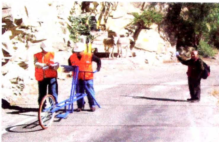
Figura N° 2.7: Tramo evaluado con el Equipo Merlín
