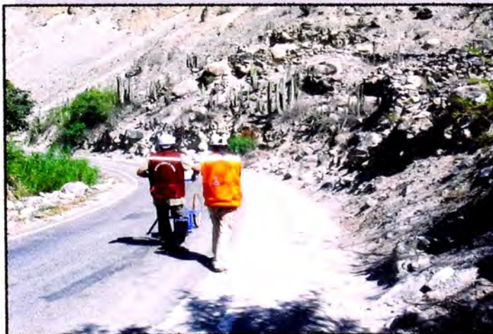
Fotografía N° 4.03: Aquí se observa una curva dentro del tramo en evaluación, factor que afecta la precisión del equipo.
