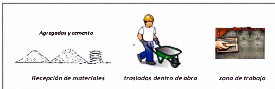
Figura N° 1.- Ejemplo flujo de proceso en la partida de tarrajeo de muros de Albañilería
