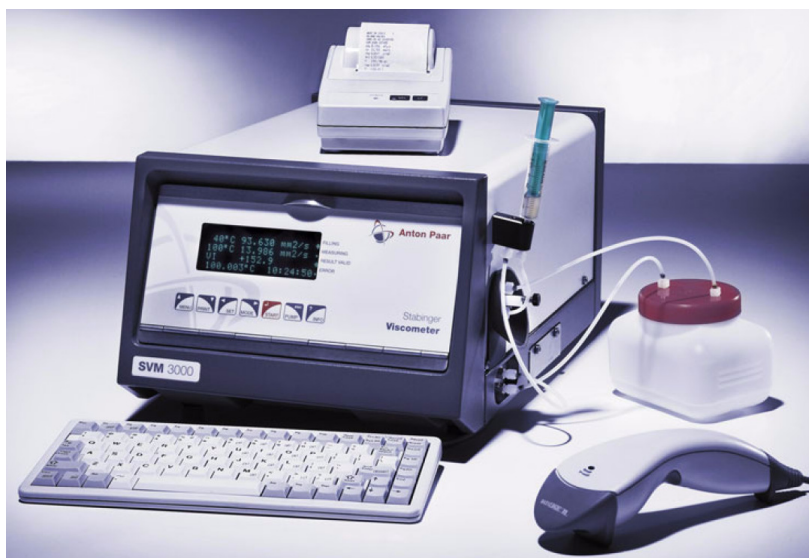
FIGURA N° 2-15 DENSIMETRO ESTACIONARIO, MODELO SVM 3000
