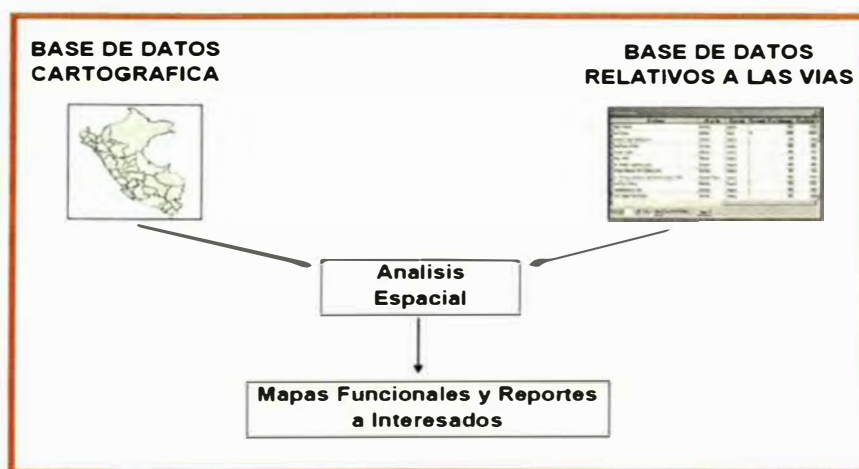
Figura N° 1.2: Esquema de un Sistema de información Geográfica.
