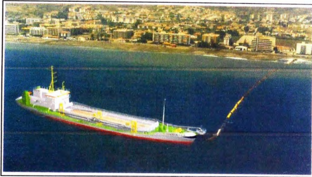
Figura N° 1.09: Acoplamiento del B/D con el Sistema de Descarga.
