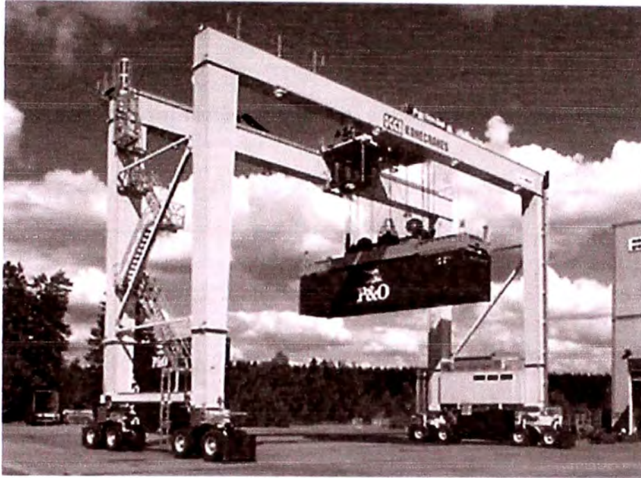
Fig. N° 2.19 Grúa de patio RTG (Rubber tire gantry crane).
