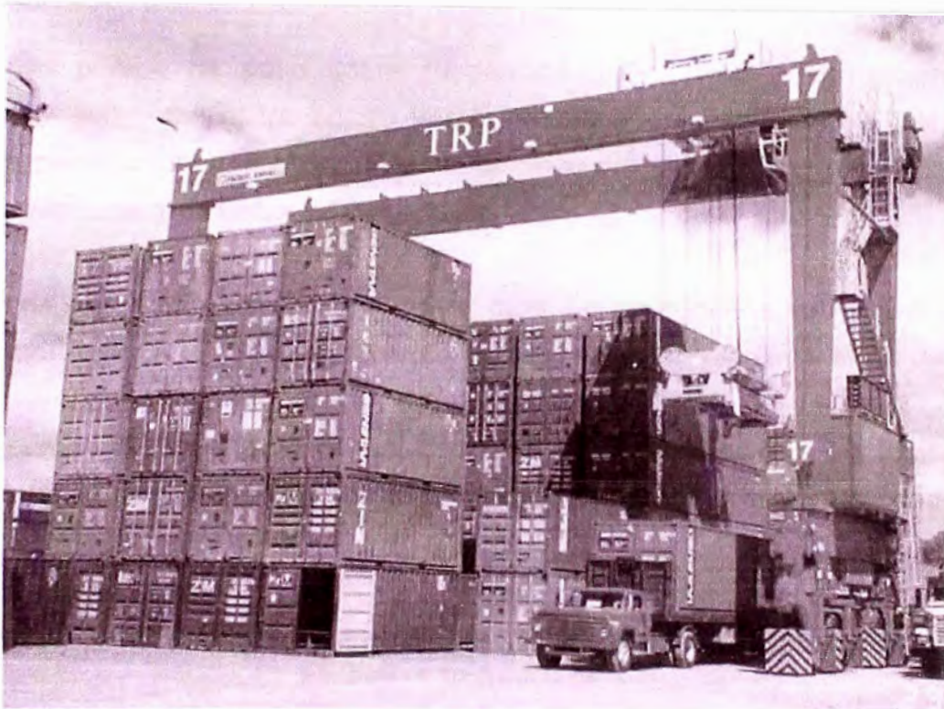
Figura N° 2.18 Pilas de contenedores con gruas de patio.
