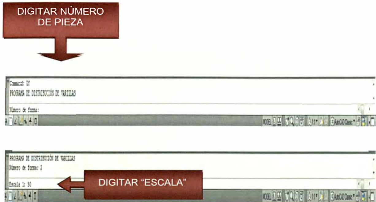
Figura N°28 : Ingreso de datos para el lisp DF
