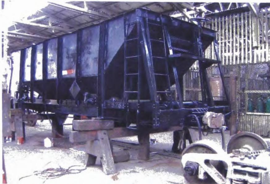
Figura 3.31: Vagones Hooper usados en el transporte de Balasto.
