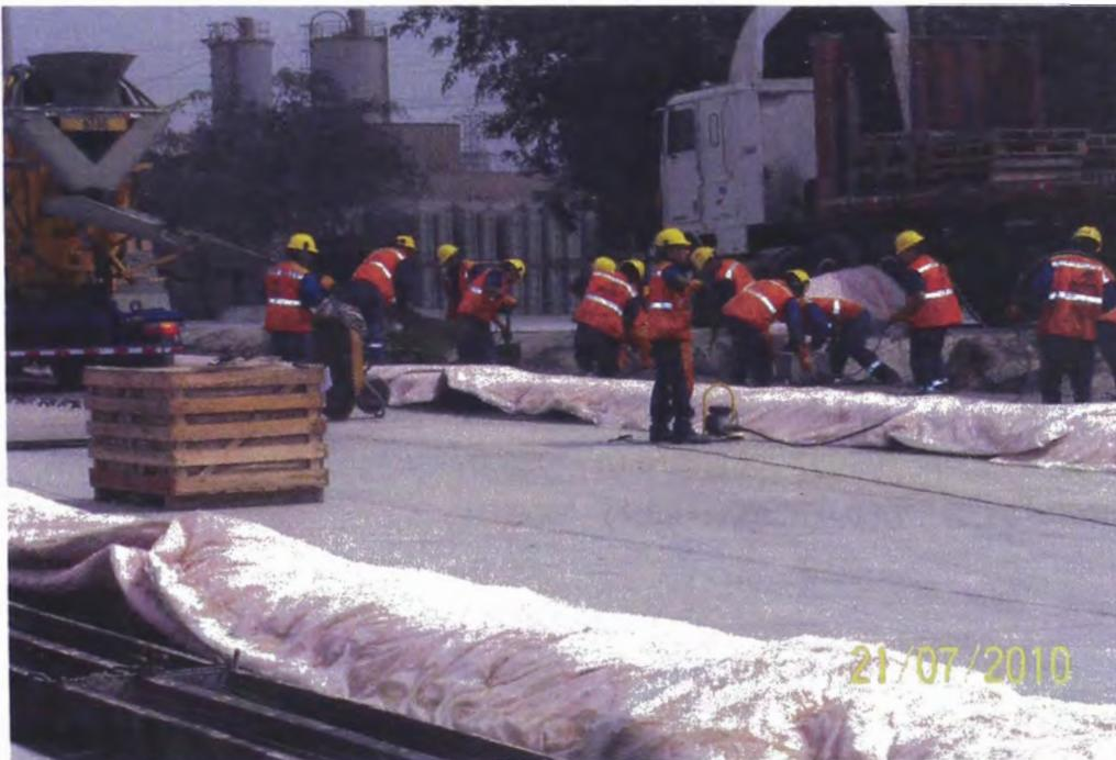
Figura 3.10: Producción de durmientes de Concreto en la Planta de Ancieta.
