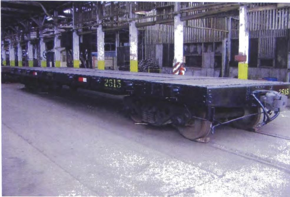
Figura 3.30: Plataforma ferroviaria usada en el montaje de la Vía Férrea.
