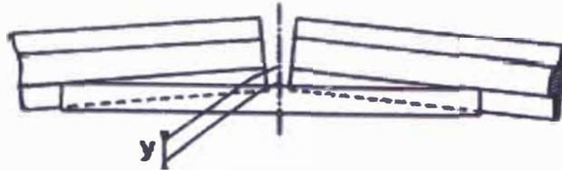
Figura 3.16: Alineamiento Geométrico de las soldaduras
