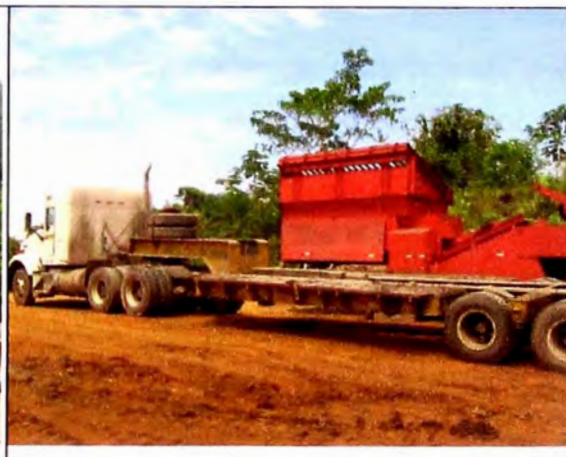
Foto 3.2: Movilización de zaranda mecánica
