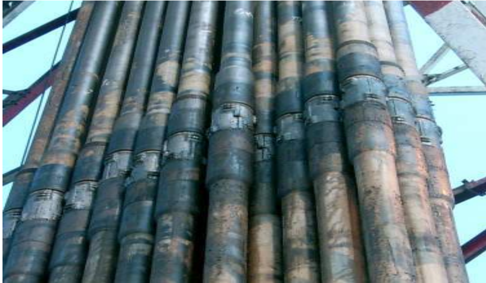
Figura 6.4. Instalación de los LoTAD en una parada en una sarta de perforación
