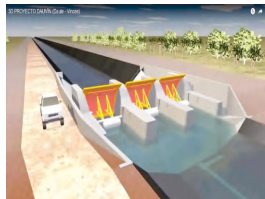
Cuadro N° 2. Derivación de ríos a diques con compuertas en Ecuador
