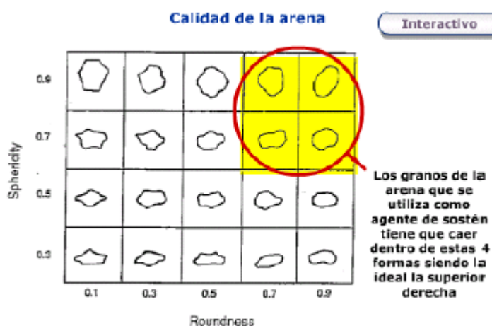
Fig. 5.5 Esfericidad y Redondez Según Norma API 56
