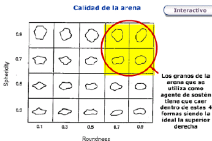
Fig. 5.5 Esfericidad y Redondez Según Norma API 56
