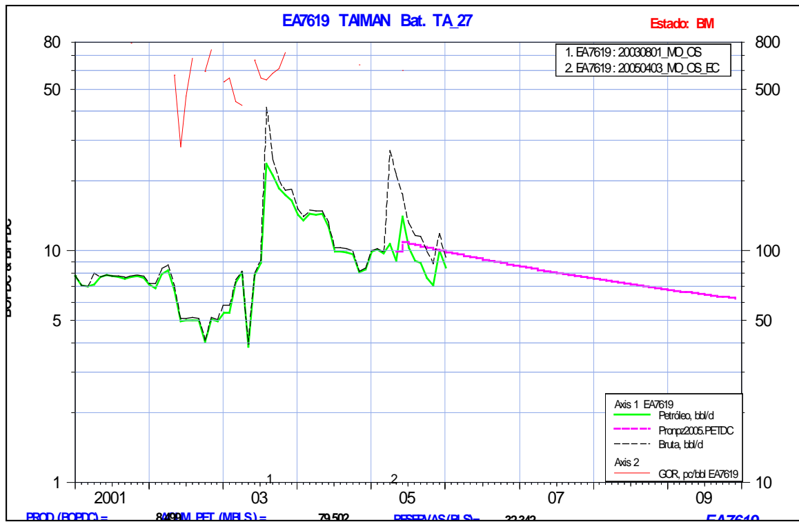
Fig. 8.19 Comportamiento productivo Frac con agente de sostén ultraligero, Pozo 7619 Taiman
