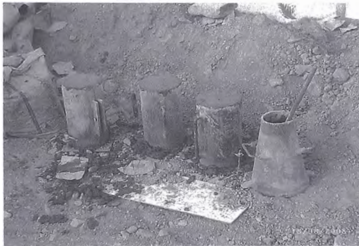
Foto 4.04 Ensayos de Concreto
