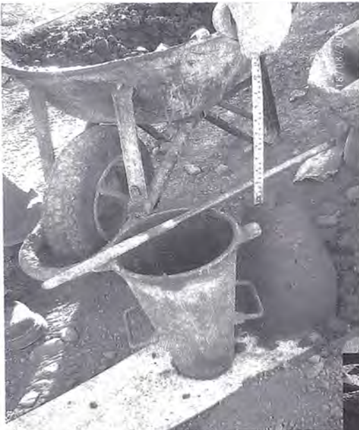
Foto 4.01 Ensayo del Slump.
