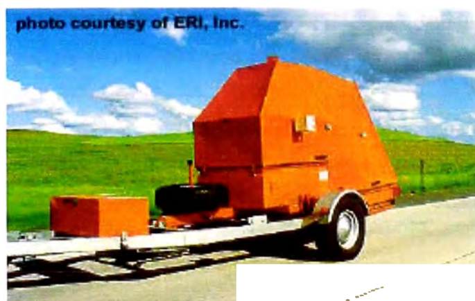
Figura N° 2.06. Equipo KUAB - FWD
