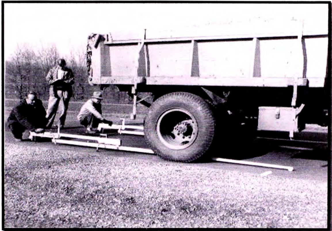
Figura N° 2.01 Alvin Benkelman - Prueba de la Viga Benkelman
