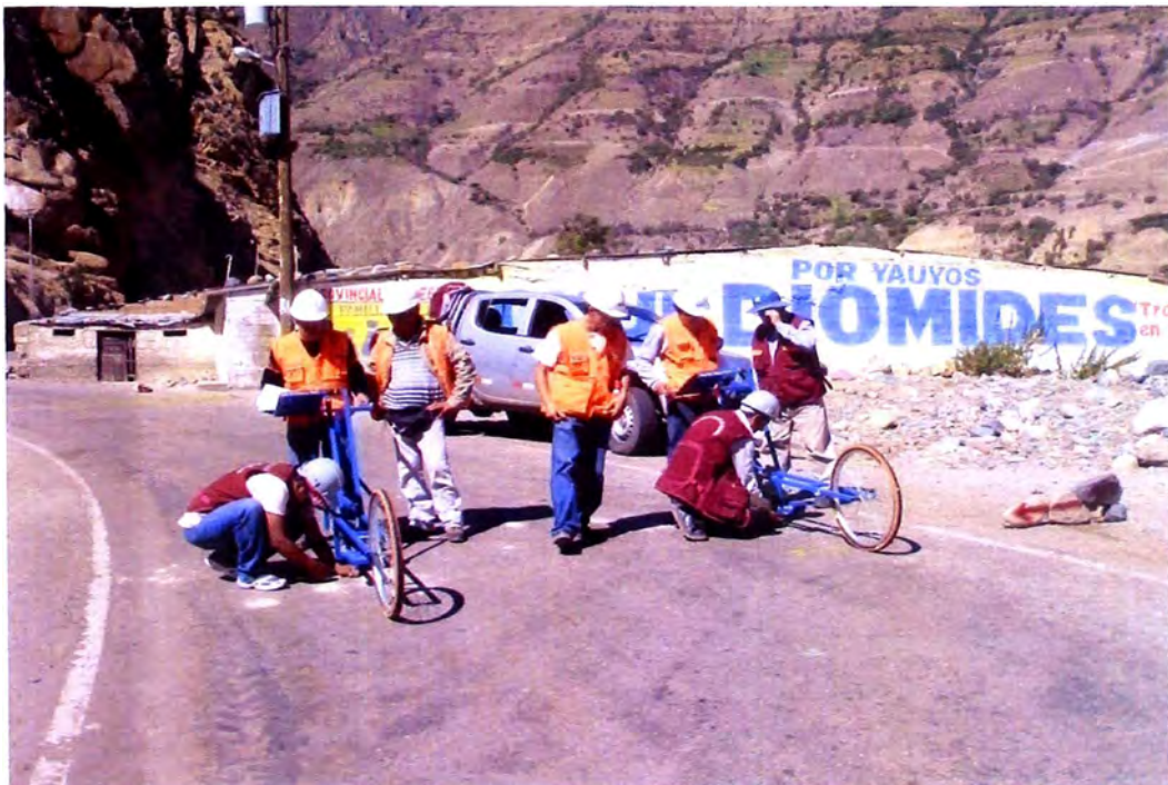
Foto N° 10: Evaluación de la rugosidad con el equipo MERLIN en el subtramo Km. 115+200 al Km. 114+800.
