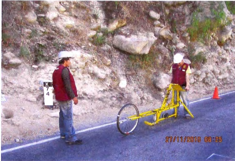
Fig. 5.09: Fotografía de la progresiva Km 74+000, empezando la toma de datos sobre el carril derecho a 1 metro del borde.
