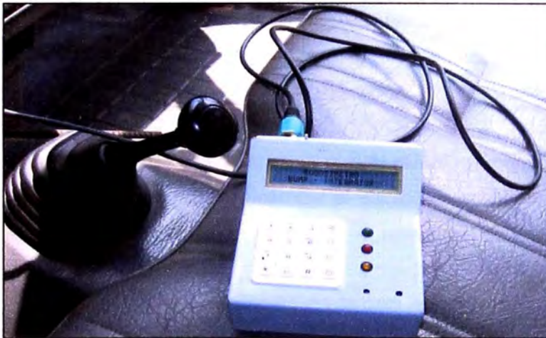
Fig. 2.14 Unidad de adquisición de datos de Rugosímetro Bump integrator.
