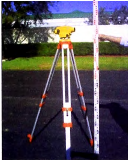
Figura 2.6 Nivel y mira topográfica
