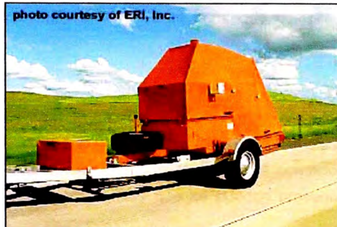
Foto N° 25: Equipo dinámico para la determinación de deflexiones (Dynalect)
