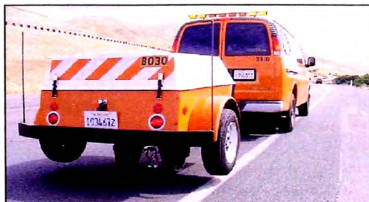
Foto N° 27: Deflectómetro de impacto para la determinación de deflexiones (Kuab)
