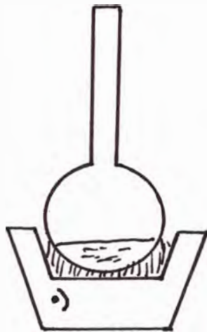
Digestión con calentamiento por 1 hora
