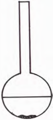
Balón Kjeldahl con muestra, óxido de magnesio, agua destilada y vaselina líquida
