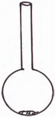
Bolón Kjeldahl con muestra, K_2SO_4 y CuSO_4 y H_2SO_4
