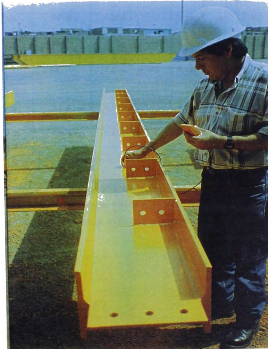
Figuras N° 20 y 21 Supervisión Técnica - Medición del Espesor de Película Seca
