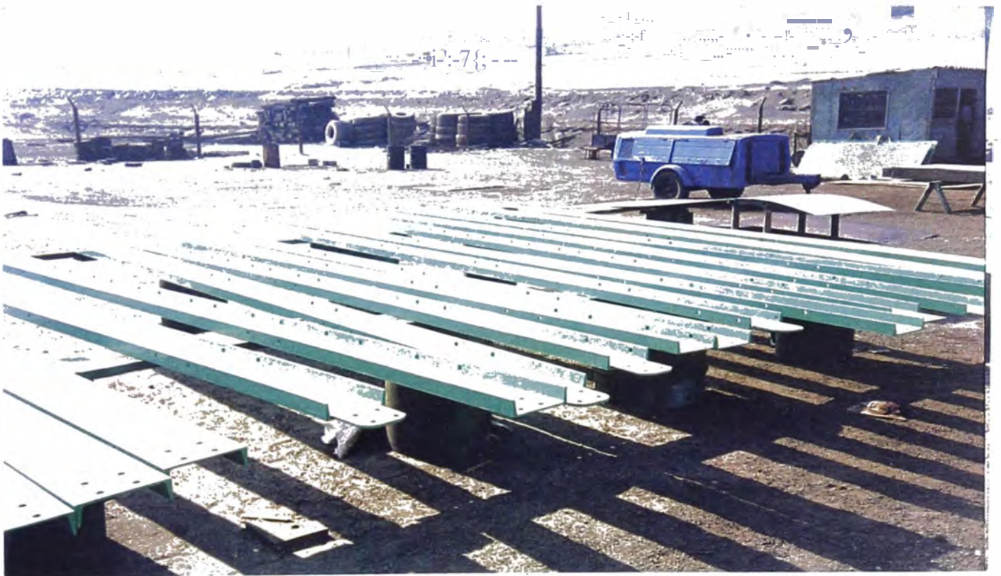
Figura N° 16 Sistema de Pintado: Zinc Rich - Epoxi / Poliamida
