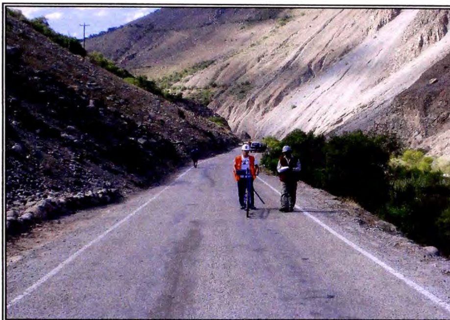
FOTO 01: Ensayo con Rugosímetro MERLIN en el Sub Tramo 1: Km. 108+000 al 107+600. Lado Derecho
