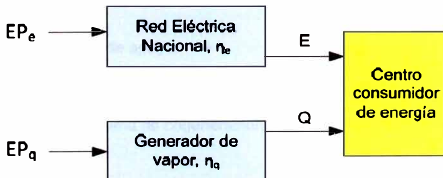
Figura N° 17. Flujo de energía de un sistema convencional.
