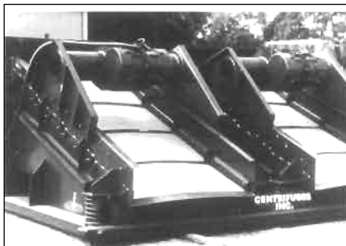
Figura 2 - 4. Primeros diseños de Zarandas Vibradoras
