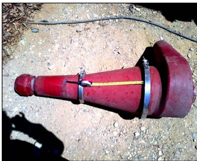
Figura 4 - 3. Desarenador de Poliuretano Termoplástico DESLIMADOR Y LIMPIADOR DE LODO.
