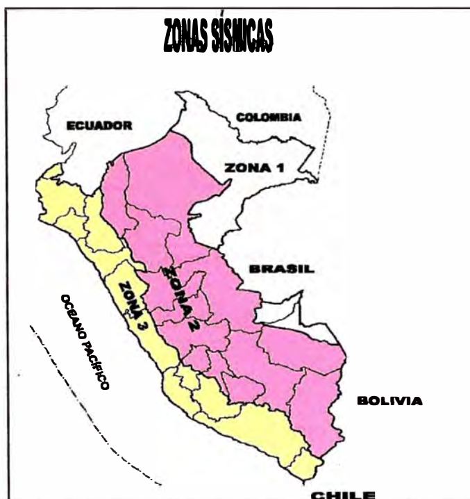
Figura 3.2: Mapa de Zonificación Sísmica considerando por la norma Técnica E-030 “Diseño Sismorresistente” del Reglamento Nacional de Edificaciones
