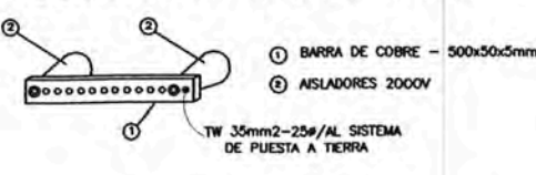
DETALLE BARRA EQUIPOTENCIAL
