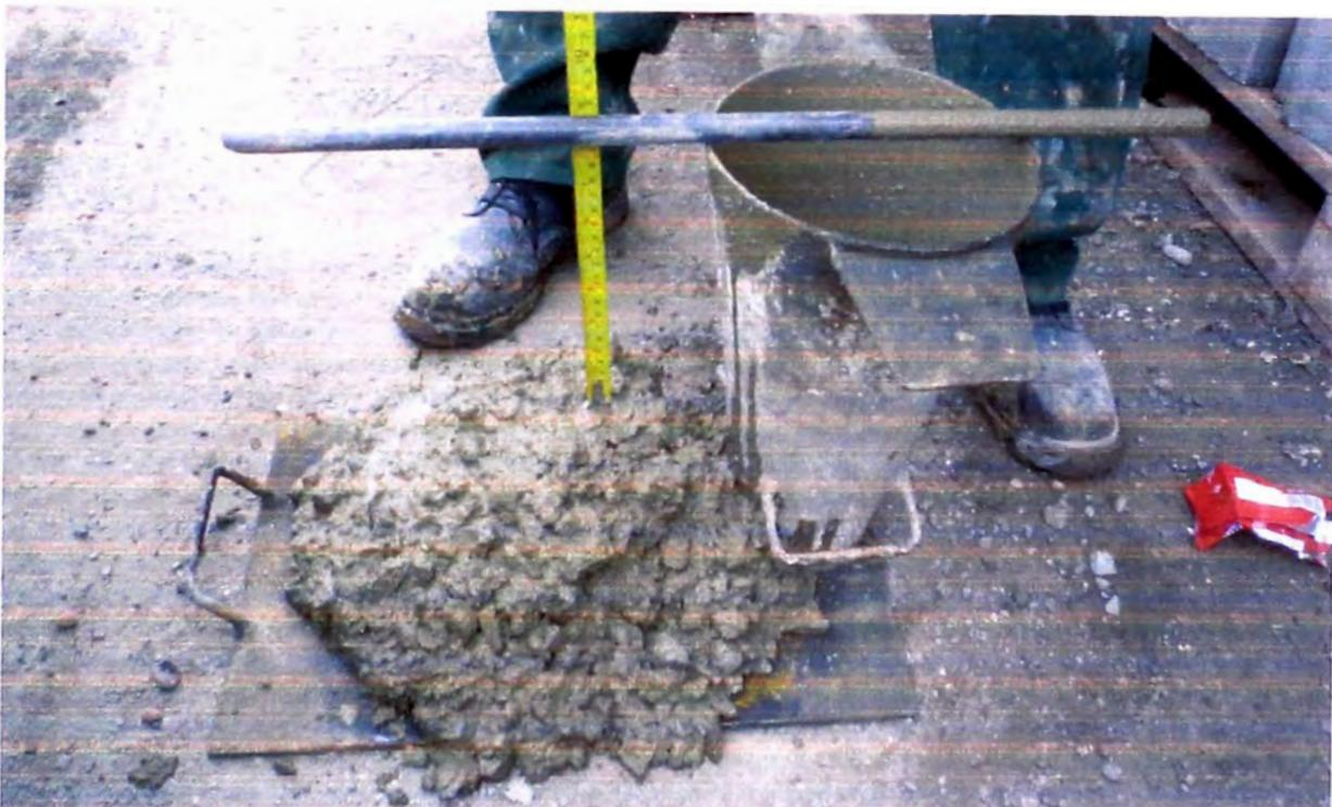
**F-18 ENSAYO DE ASENTAMIENTO EN OBRA CON EL ADITIVO
