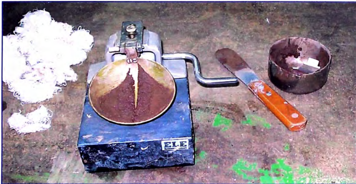
Foto N° 17. – Ensayo de las muestras para la obtención de su Límite líquido.
