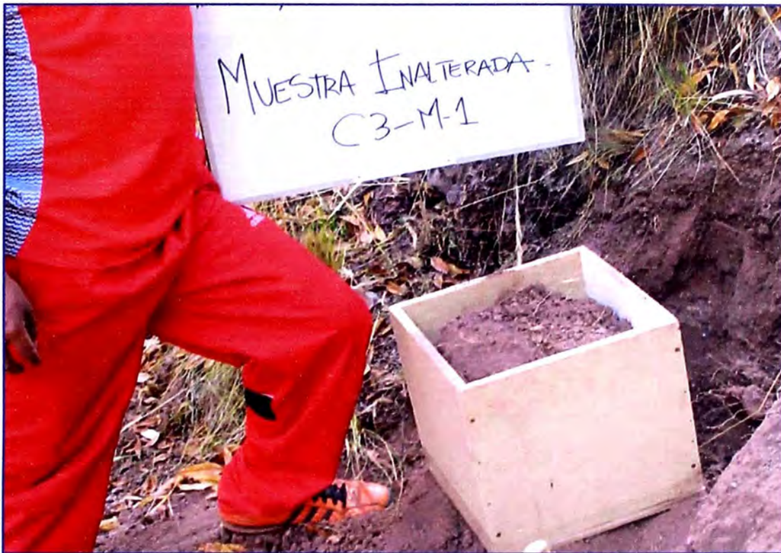
Foto N° 9. – Muestra inalterada zona IB, para la posterior impermeabilización.
