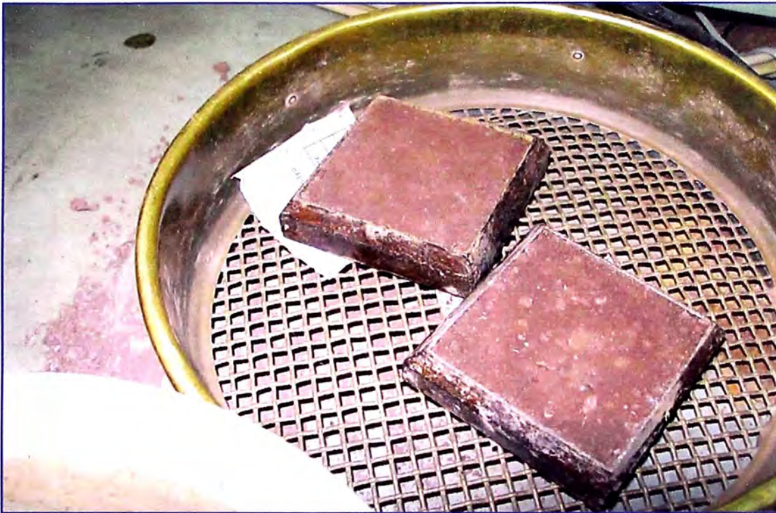
Foto N° 21. – Muestras de suelo remoldeadas, zona IB, para el ensayo de Corte Directo.
