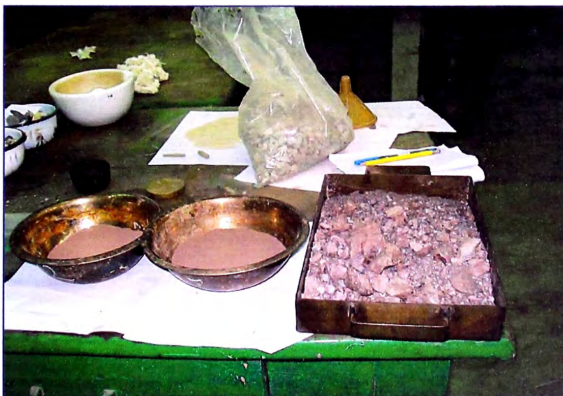
Foto N° 16. – Tamizado por la malla N°40, para la obtención de los límites de consistencia.
