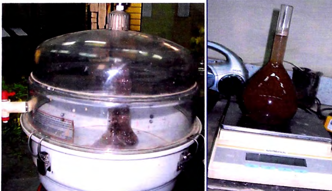
Foto N° 19. – Bomba de vacío y picnómetro, utilizados en la determinación de la gravedad específica de las muestras ( G_s ).
