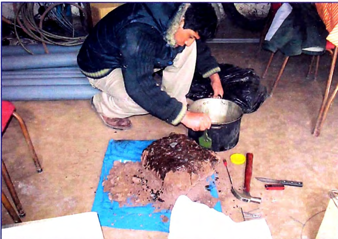
Foto N° 12. – Impermeabilizado de muestras, con parafina diluida.
