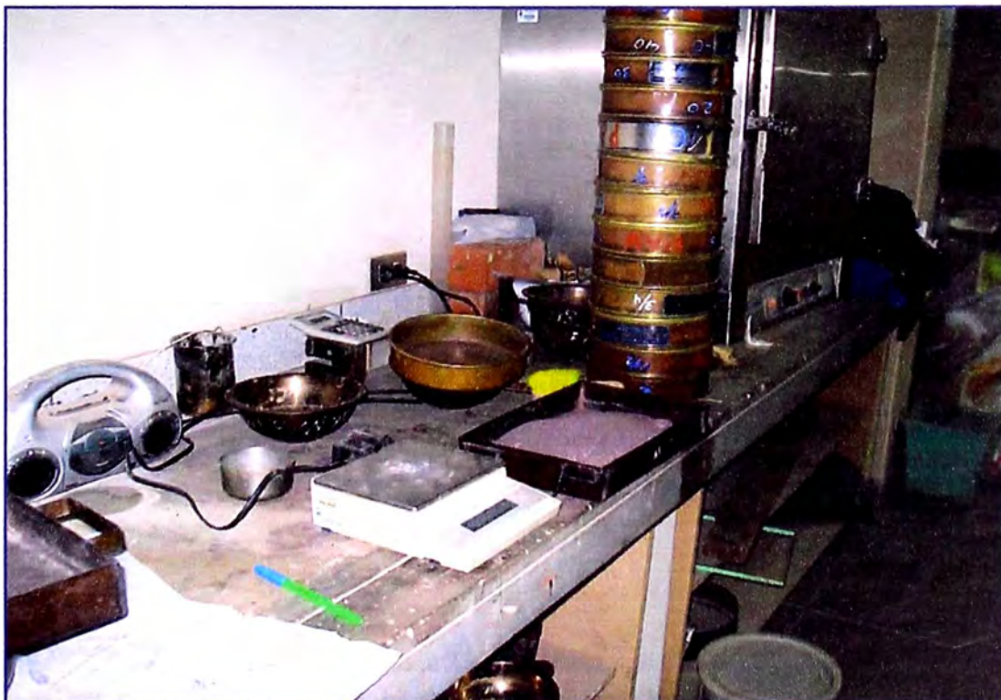
Foto N° 14. – Análisis granulométrico por tamizado.
