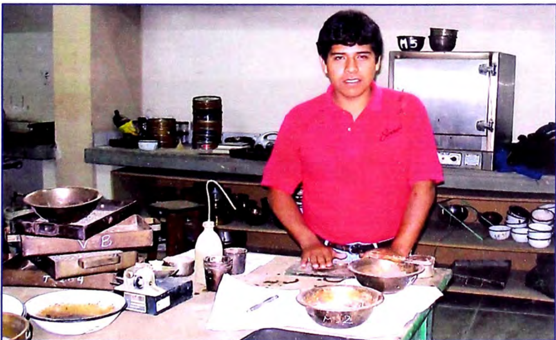
Foto N° 18. – Ensayo de las muestras para la obtención de su límite plástico.
