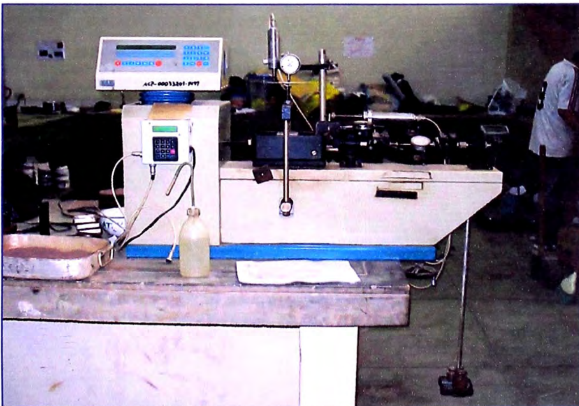
Foto N° 22. – En la vista se aprecia el equipo de Corte Directo del Laboratorio de Mecánica de Suelos de la FIC-UNI, usado en la realización de los ensayos de las muestras.
