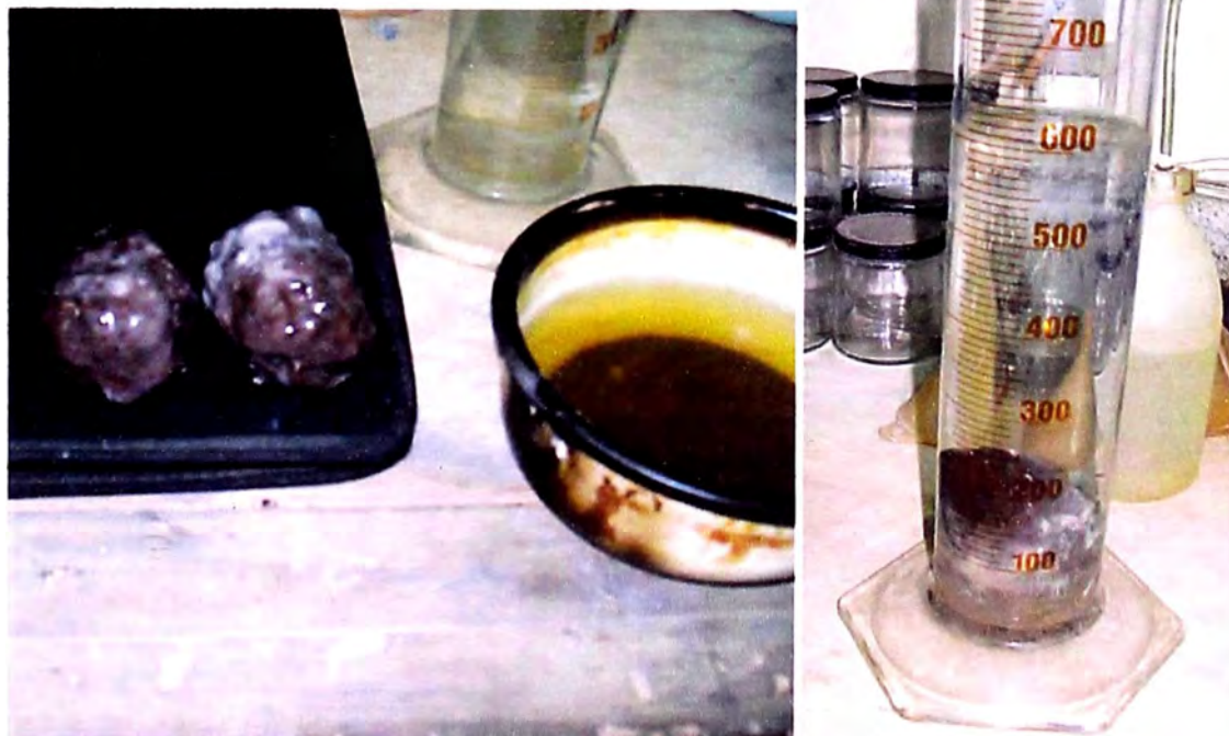
Foto N° 20. – Muestras y equipos, necesarios para la obtención del peso volumétrico de las muestras
