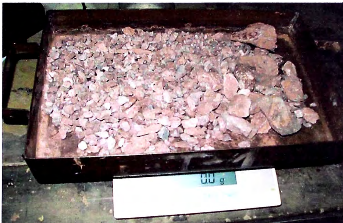
Foto N° 15. – Las partículas identificadas como grava en campo, se disgregaron al lavar las muestras por la malla N°200.
