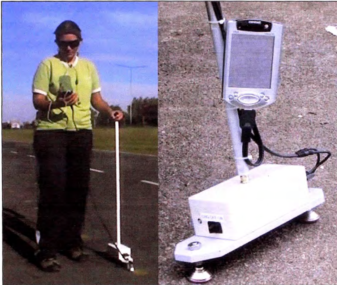
Figura 2.4: Perfilómetro Face Dipstick (Método Clase 1)
