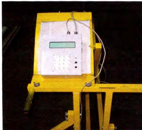
Figura 6.5 Adquisidor de datos del equipo
