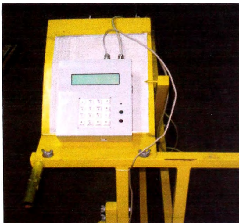
Figura 3.17: Unidad de almacenamiento de datos con pantalla (Fuente: IIFIC-UNI)
