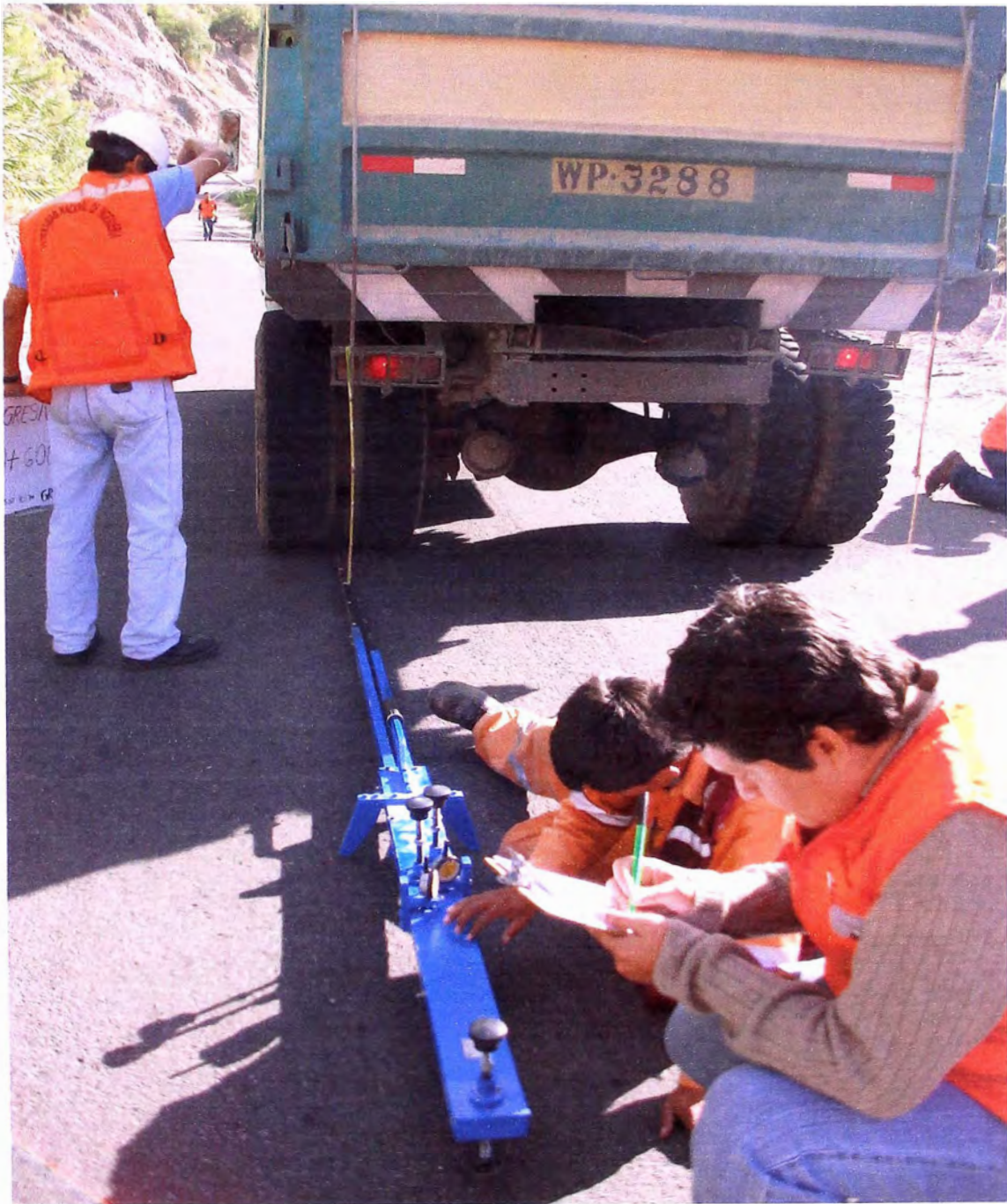
Foto N°9: Camión con carga en el eje trasero de 8.2 toneladas.
