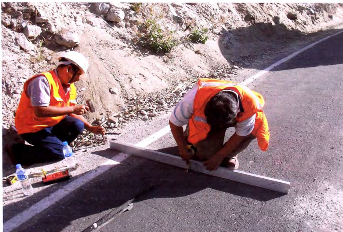
Foto N°6: La medición del ahuellamiento del pavimento Prog: 101+200 Km.
