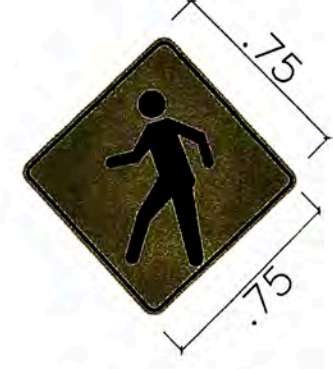
P - 48 SEÑAL CRUCE DE PEATONES
