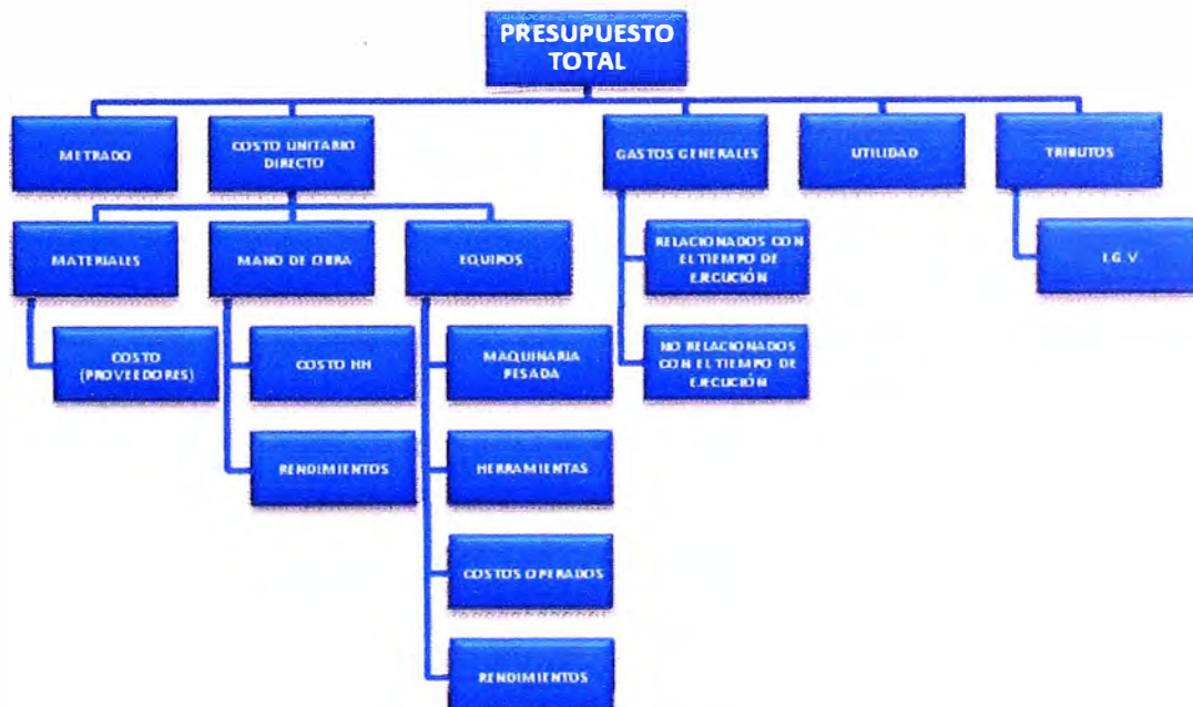
Figura N° 2.01: Esquema de un Presupuesto
