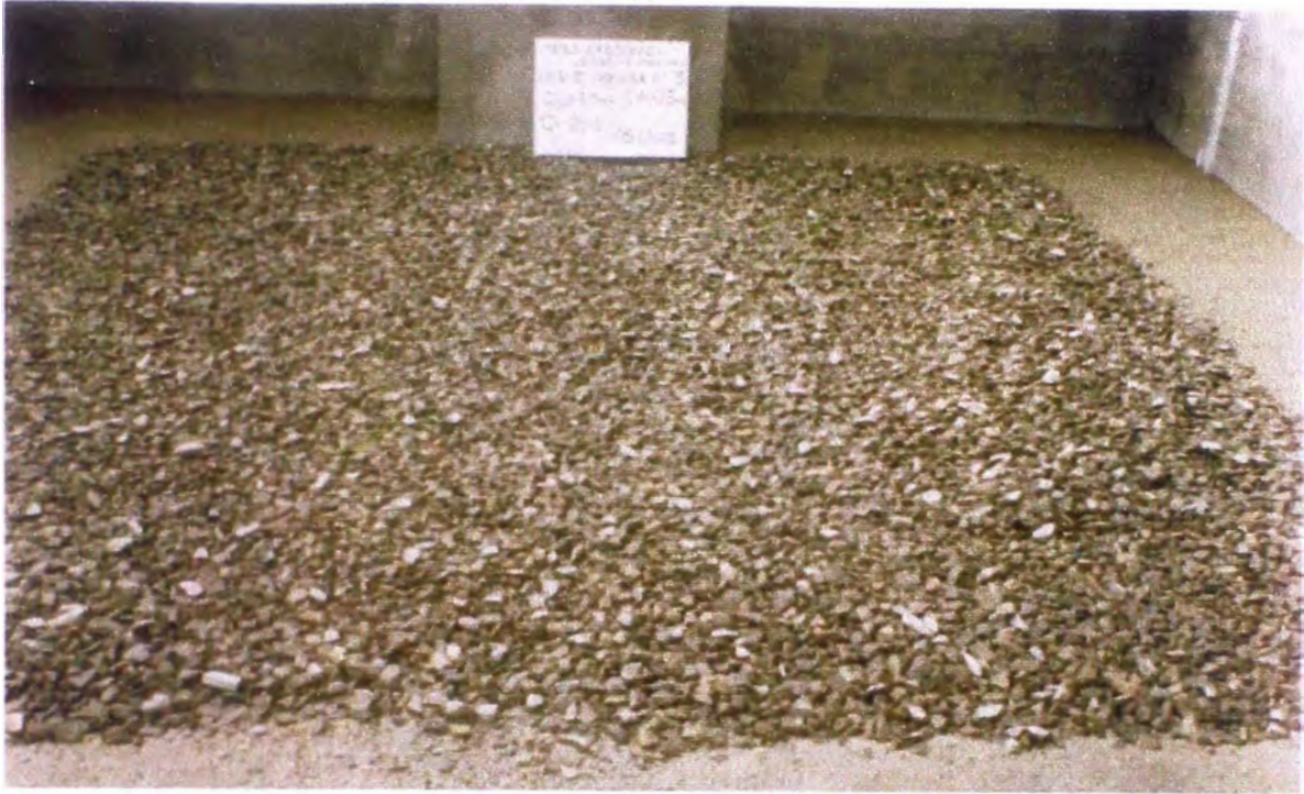
Fotografía N° 32: Fase II - Prueba 3 y 4 : ( Q = 0.02 \text{ m}^3/\text{s} , h_{CA} = 0.25 \text{ m} y 0.50 \text{ m} , d_{50} = 17.88 \text{ mm} ). Vista de la poza de erosión, después de dos horas de prueba. No hubo proceso de erosión.
