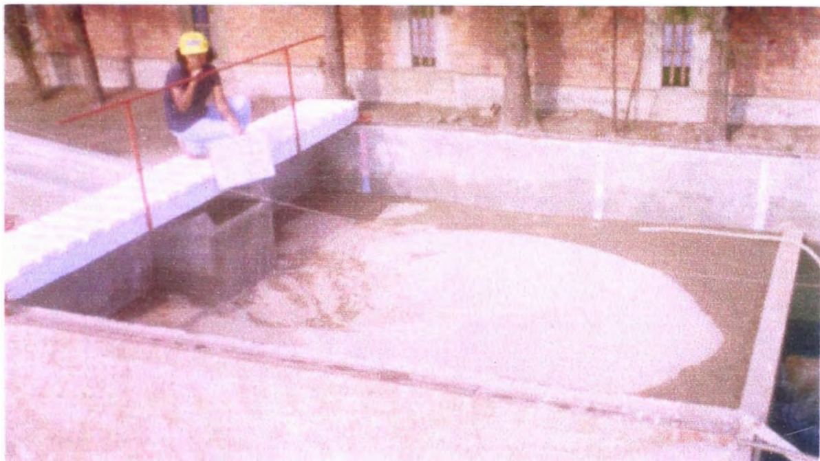
Fotografía N° 04: Fase I - Prueba N°1 ( Q = 0.02 \text{ m}^3/\text{s} , h_{CA} = 0.10 \text{ m} , d_{50} = 1,60 \text{ mm} ).
