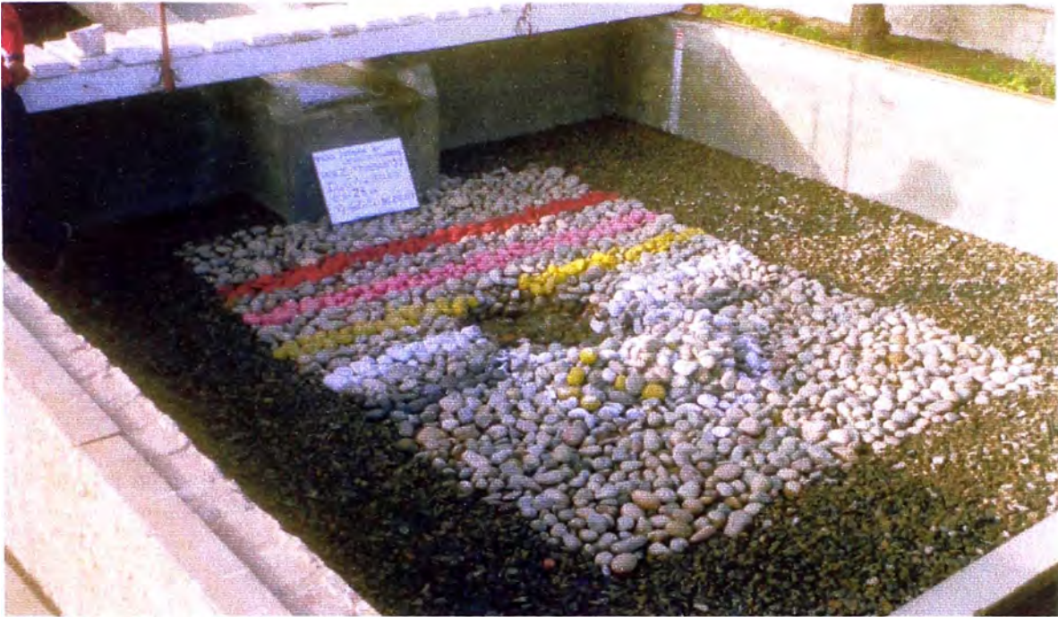
Fotografía N° 42: Fase III-Prueba 11:( Q = 0.06 \text{ m}^3/\text{s} , h_{CA} = 0.25 \text{ m} , d_{50} = 49.08\text{mm} ). Vista de la poza de erosión después de dos horas de prueba. La profundidad de erosión fue de 0.128 \text{ m} .
