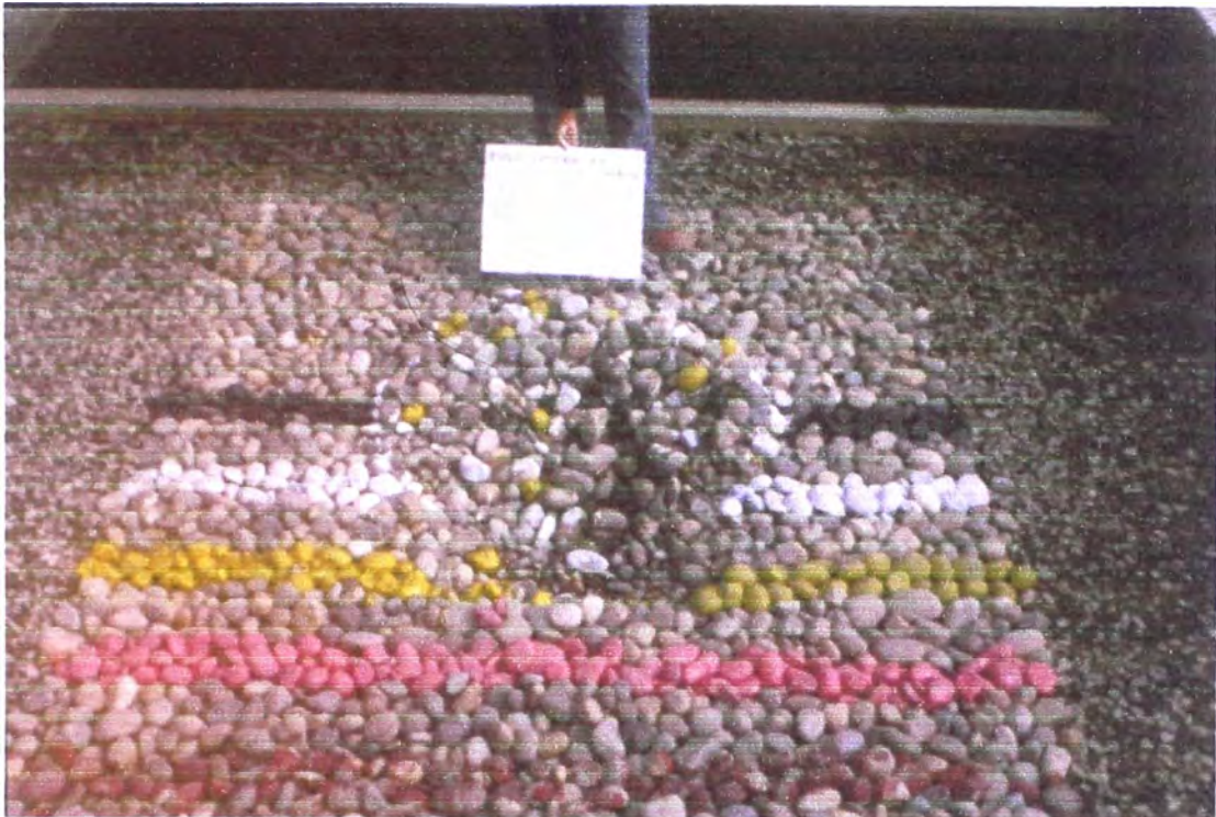
Figura 3.9: Fase III - Prueba 9 ( Q = 0,06 \text{ m}^3/\text{s} , h_{ca} = 0,05 \text{ m} d_{50} = 49,08 \text{ mm} y d_{85} = 70,53 \text{ mm} ). Vista de la poza de erosión, después de dos horas de prueba. La profundidad de erosión fue de 0,166 \text{ m} .
