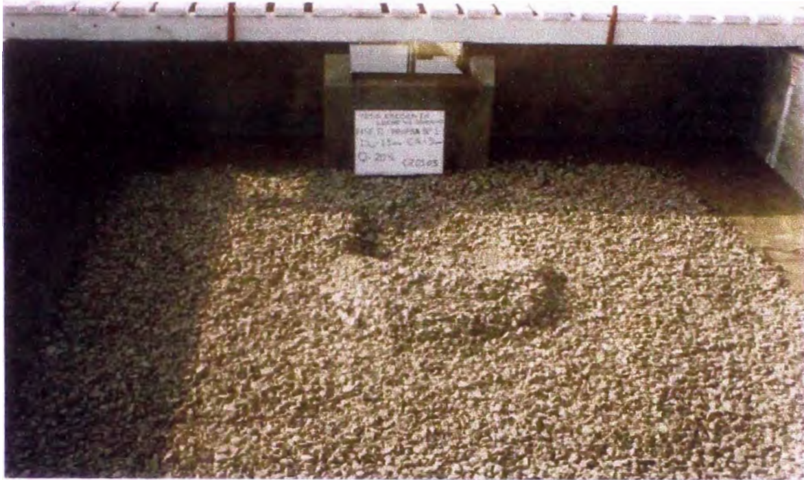
Fotografía N° 21: Fase II - Prueba 1 ( Q = 0.02 \text{ m}^3/\text{s} h_{CA} = 0.05 \text{ m} , d_{50} = 17.88 \text{ mm} ). Vista de la poza de erosión después de dos horas de prueba. La profundidad fue de 0.155 m.
