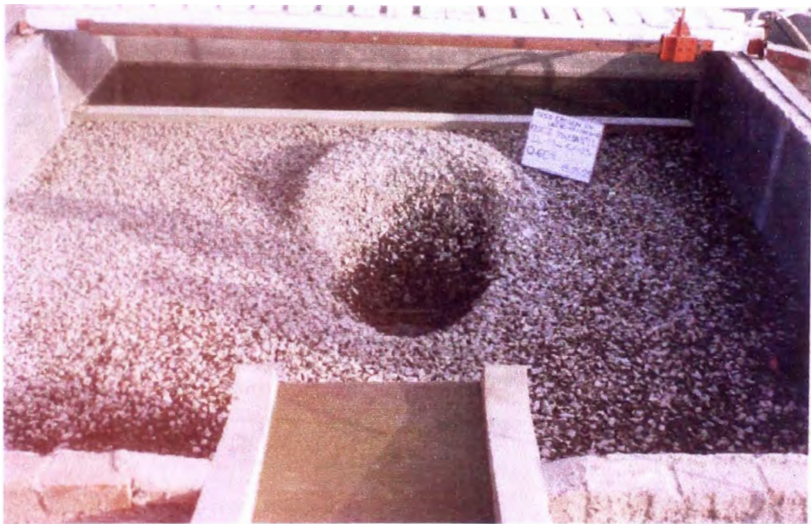
Fotografía N° 30:Fase II - Prueba 11:( Q = 0.06 \text{ m}^3/\text{s} , h_{CA} = 0.25 \text{ m} , d_{50} = 17.88 \text{ mm} ). Vista de la poza de erosión después de dos horas de prueba. La profundidad de erosión fue de 0.30 m.
