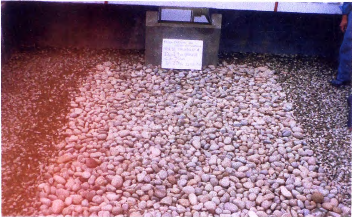
Fotografía N° 34: Fase III - Prueba 3: ( Q = 0.02 \text{ m}^3/\text{s} , h_{CA} = 0.25 \text{ m} , d_{50} = 49.08 \text{ mm} ). Vista del cuenco después de dos horas de prueba. No se produjo erosión.
