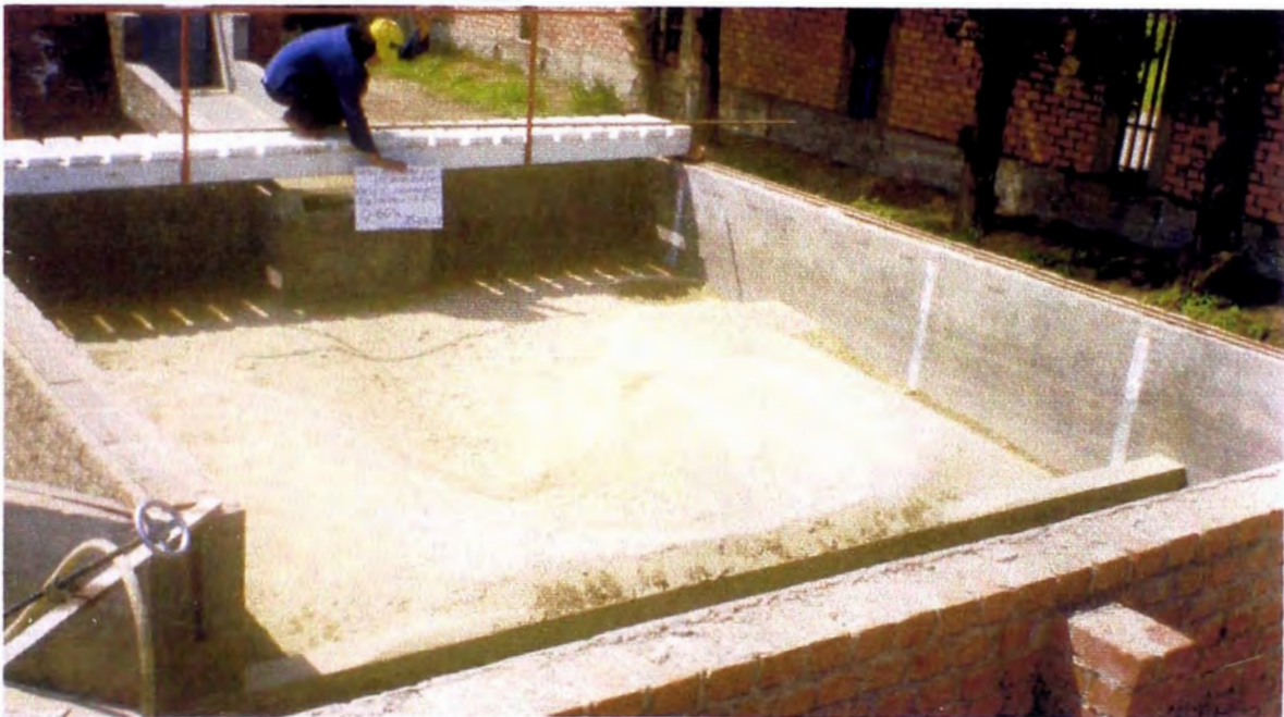
Fotografía N° 17: Fase I - Prueba 11. ( Q = 0.06 \text{ m}^3/\text{s} , h_{CA} = 0.25 \text{ m} , d_{50} = 1.60 \text{ mm} ) Vista del pozo de erosión después de 2 horas de prueba. La profundidad de erosión fue de 0.349 m.
