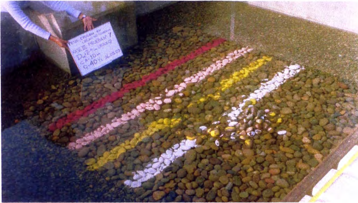
Fotografía N° 38: Fase III-Prueba 7:( Q = 0.04 \text{ m}^3/\text{s} , h_{CA} = 0.10 \text{ m} , d_{50} = 49.08 \text{ mm} ). Vista de la poza de erosión después de dos horas de prueba. La profundidad de erosión fue de 0.217 m.
