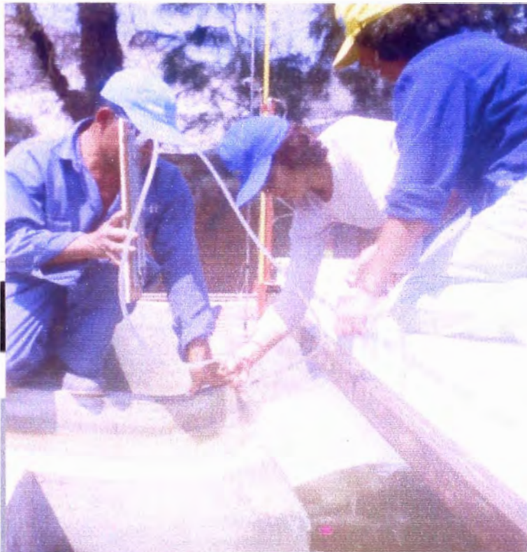
Fotografía N° 10: Fase I – Prueba 7. ( Q = 0.04 \text{ m}^3/\text{s} , h_{CA} = 0.25 \text{ m} , d_{50} = 1.60 \text{ mm} ). Se observa la toma de datos de velocidad en el ski, con el Tubo de Pitot.
