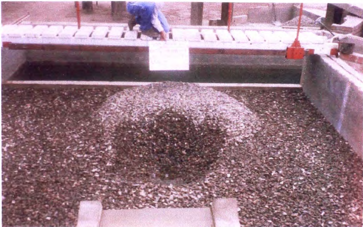
Fotografía N° 28: Fase II - Prueba 9:( Q = 0.06 \text{ m}^3/\text{s} , h_{CA} = 0.05 \text{ m} , d_{50} = 17.88 \text{ mm} ). Vista de la poza de erosión después de dos horas de prueba. La profundidad de erosión fue de 0.347 \text{ m} .
