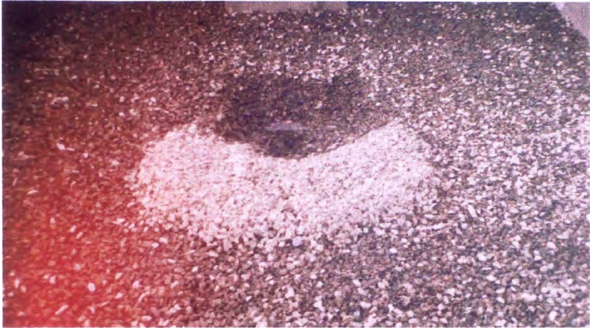
Fotografía N° 27: Fase II - Prueba 8:( Q = 0.04 \text{ m}^3/\text{s} , h_{CA} = 0.25 \text{ m} , d_{50} = 17.88 \text{ mm} ). Vista de la poza de erosión después de dos horas de prueba. La profundidad de erosión fue de 0.162 \text{ m} .
