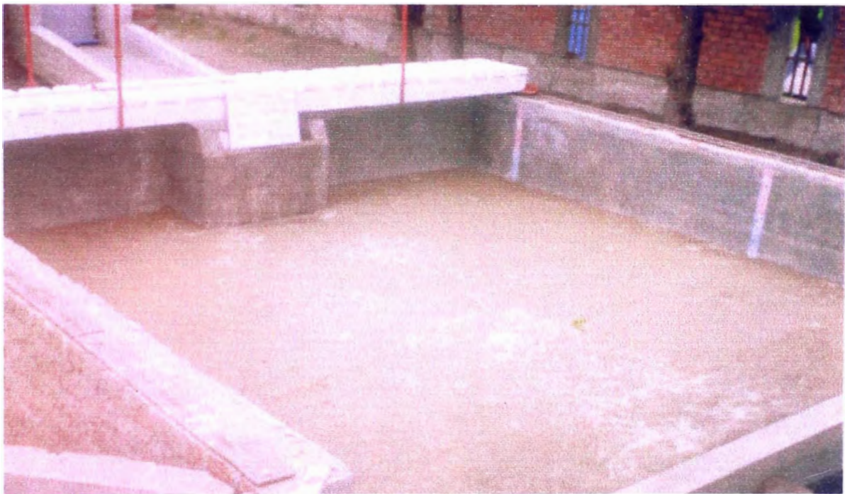
Fotografía N° 06: Fase I - Prueba 3. ( Q = 0.02 \text{ m}^3/\text{s} ; h_{CA} = 0.50 \text{ m} ; d_{50} = 1.60 \text{ mm} ) Vista del cuenco después de dos horas de prueba. No se produjo erosión.
