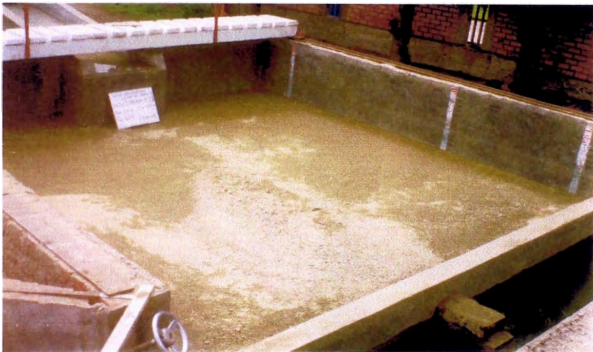
Fotografía N° 19: Fase I – Prueba 12. ( Q = 0.06 \text{ m}^3/\text{s} , h_{CA} = 0.5 \text{ m} , d_{50} = 1.60 \text{ mm} ) Vista de la erosión superficial que ha originado el chorro después de 2 horas de prueba. Esta fue de 0.076 \text{ m} .
