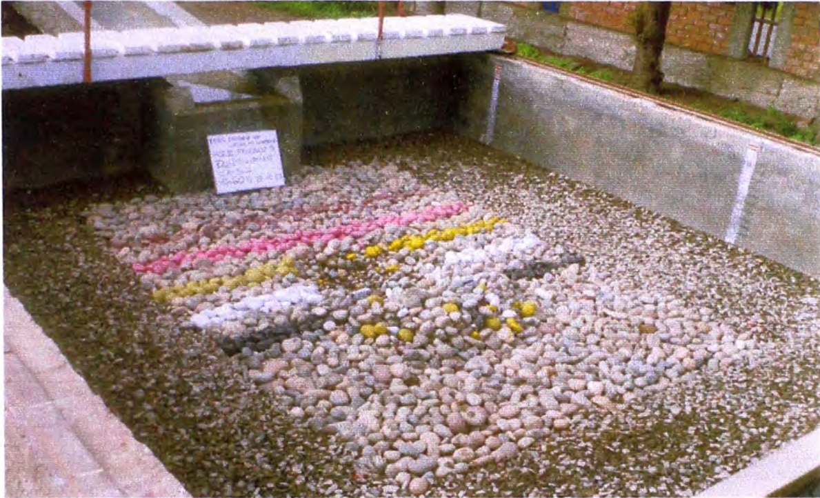
Fotografía N° 40: Fase III- Prueba 9: ( Q = 0.06 \text{ m}^3/\text{s} , h_{CA} = 0.05 \text{ m} , d_{50} = 49.08 \text{ mm} ). Vista de la poza de erosión después de dos horas de prueba. La profundidad de erosión fue de 0.166 \text{ m} .
