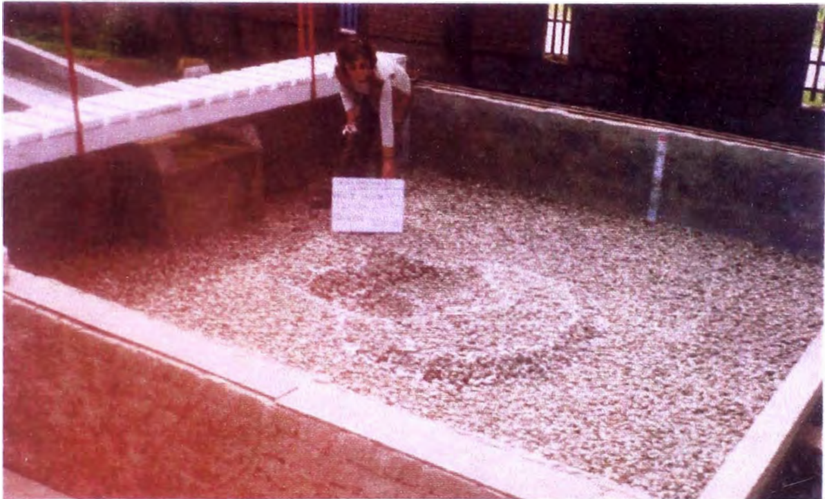
Fotografía N° 33: Fase II - Prueba 5: ( Q = 0.04 \text{ m}^3/\text{s} , h_{CA} = 0.05 \text{ m} , d_{50} = 17.88 \text{ mm} ). Vista de la poza de erosión, después de dos horas de prueba. La profundidad de erosión fue de 0.273 \text{ m} .
