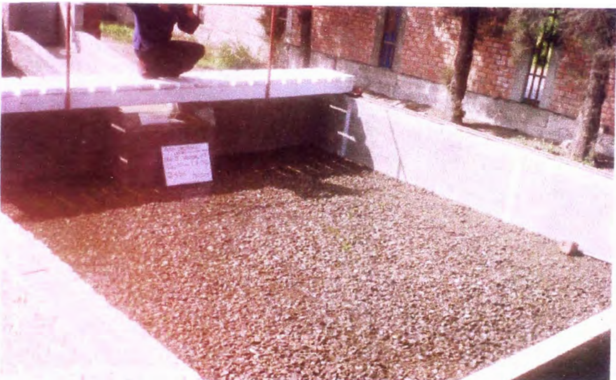
Fotografía N° 26: Fase II - Prueba 7: ( Q = 0.04 \text{ m}^3/\text{s} , h_{CA} = 0.50 \text{ m} , d_{50} = 17.88 \text{ mm} ) Vista de la poza de erosión después de dos horas de prueba. No se produjo erosión.
