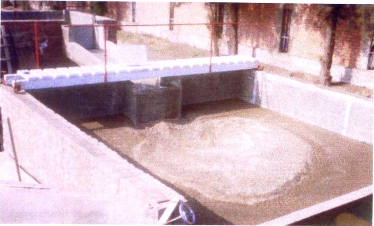
Fotografía N° 07: Fase I - Prueba 4. ( Q = 0.02 \text{ m}^3/\text{s} ; h_{CA} 0.05 \text{ m} ; d_{50} = 1.60 \text{ mm} ) Se observa la poza de erosión después de dos horas de prueba. La profundidad fue de 0.183 \text{ m}
