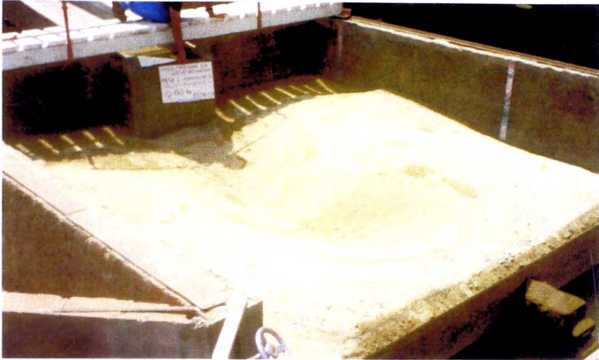
Fotografía N° 13: Fase I - Prueba 9. ( Q = 0.06 \text{ m}^3/\text{s} , h_{CA} = 0.05 \text{ m} , d_{50} = 1.60 \text{ mm} ). Vista del pozo de erosión después de 2 horas de prueba. La profundidad de erosión fue de 0.389 \text{ m} .
