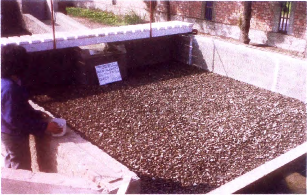
Fotografía N° 31:Fase II-Prueba 12:( Q = 0.06 \text{ m}^3/\text{s} , h_{CA} = 0.50 \text{ m} , d_{50} = 17.88 \text{ mm} ). Vista del cuenco. Después de dos horas de prueba, no se produjo erosión.
