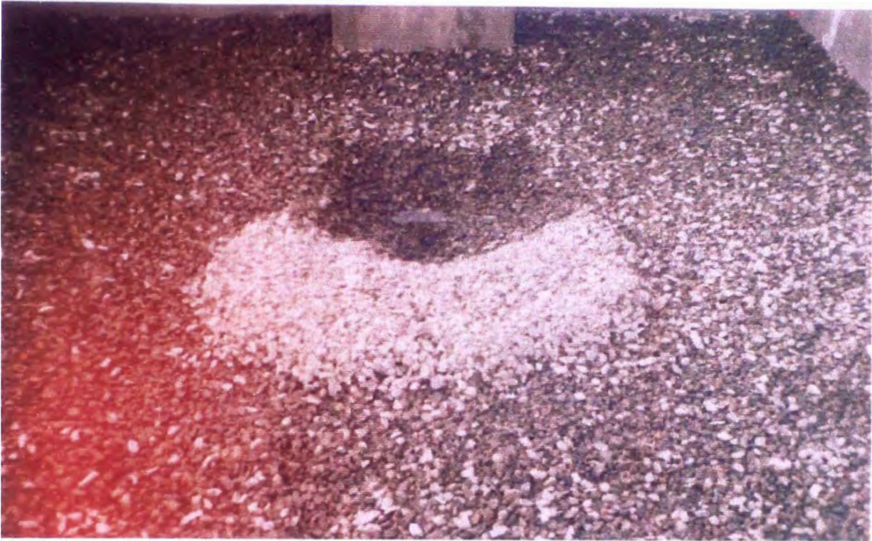
Fotografía N° 25: Fase II - Prueba 6: ( Q = 0.04 \text{ m}^3/\text{s} , h_{CA} = 0.10 \text{ m} , d_{50} = 17.88 \text{ mm} ). Vista de la poza de erosión después de dos horas de prueba. La profundidad de erosión fue de 0.251 m.
