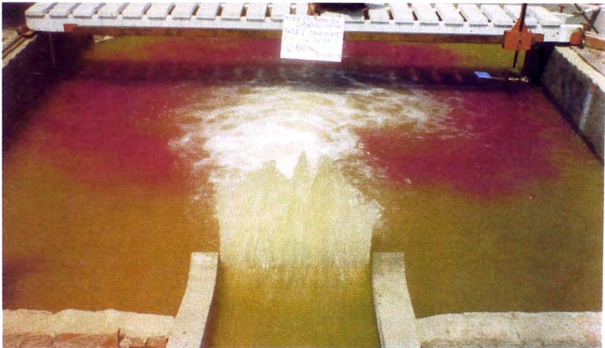
Fotografía N° 14: Fase I - Prueba 10. ( Q = 0.06 \text{ m}^3/\text{s} , h_{CA} = 0.10 \text{ m} , d_{50} = 1.60 \text{ mm} ) Vista de la distribución del flujo en el cuenco . Para ello se utilizó un trazador de color púrpura denominado permanganato de potasio.
