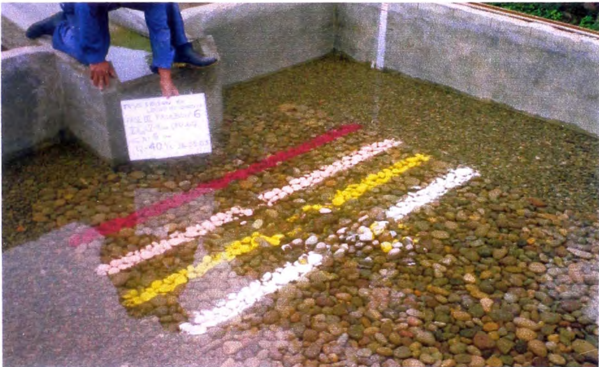
Fotografía: Fase III-Prueba 6: ( Q = 0.04 \text{ m}^3/\text{s} , h_{CA} = 0.05 \text{ m} , d_{50} = 49.08 \text{ mm} ). Vista de la poza de erosión después de dos horas de prueba. La profundidad de erosión fue de 0.137 \text{ m} .
