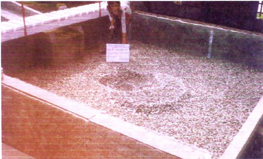
Figura 3.8: Fase II - Prueba 5. ( Q = 0,04 \text{ m}^3/\text{s} , h_{CA} = 0,05 \text{ m} , d_{50} = 17,88 \text{ mm} y d_{85} = 23,43 \text{ mm} ). Vista de la poza de erosión, después de dos horas de prueba. La profundidad de erosión fue de 0,273 \text{ m} .
