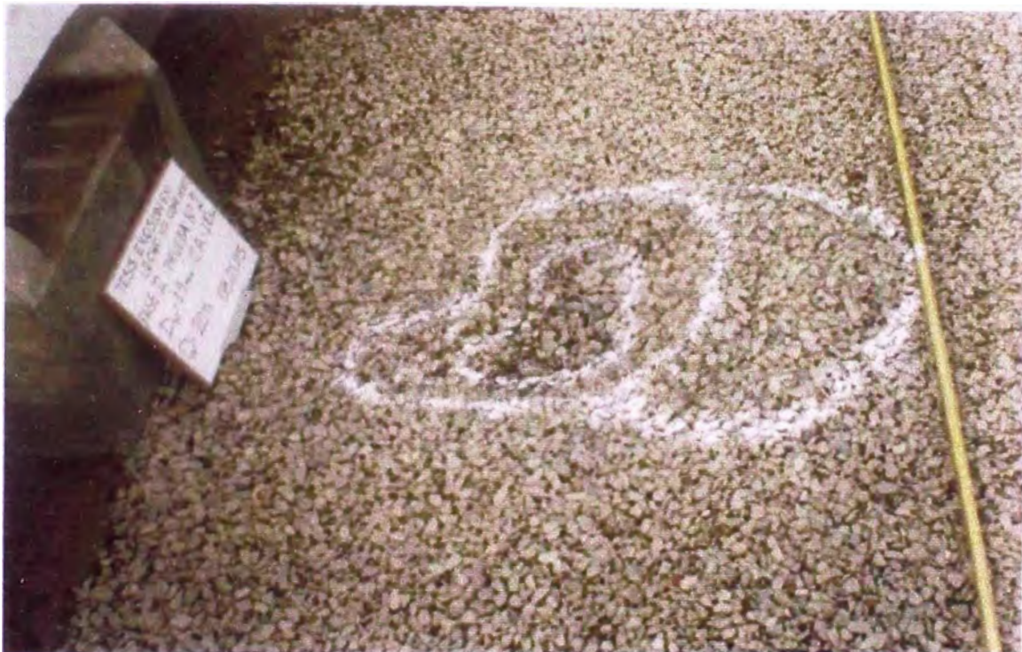
Fotografía N° 22: Fase II - Prueba 2 ( Q = 0.02 \text{ m}^3/\text{s} , h_{CA} = 0.10 \text{ m} , d_{50} = 17.88 \text{ mm} ). Vista de la poza de erosión, después de dos horas de prueba. La profundidad de erosión fue de 0.150 m.
