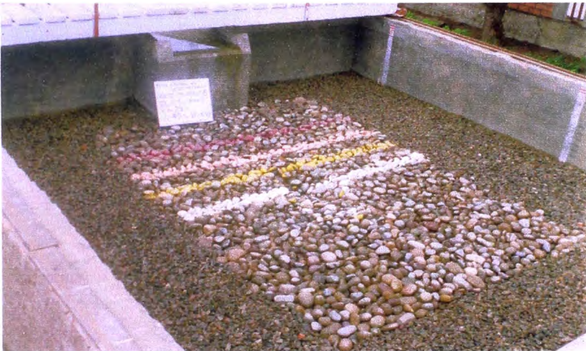
Fotografía N° 39: Fase III-Prueba 8:( Q = 0.04 \text{ m}^3/\text{s} , h_{CA} = 0.25 \text{ m} , d_{50} = 49.08 \text{ mm} ). Vista de la poza de erosión después de dos horas de prueba. La profundidad de erosión fue de 0.062 m.
