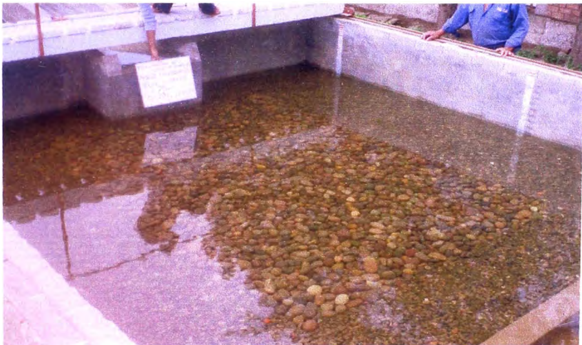
Fotografía N° 35: Fase III - Prueba 4: ( Q = 0.02 \text{ m}^3/\text{s} , h_{CA} = 0.50 \text{ m} , d_{50} = 49.08 \text{ mm} ). Vista del cuenco después de dos horas de prueba. De modo similar a la prueba anterior no se produjo erosión.
