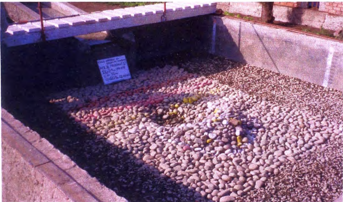
Fotografía N° 43: Fase III-Prueba 12:( Q = 0.06 \text{ m}^3/\text{s} , h_{CA} = 0.10 \text{ m} , d_{50} = 49.08\text{mm} ). Vista de la poza de erosión después de dos horas de prueba. La profundidad de erosión fue de 0.171 \text{ m} .
