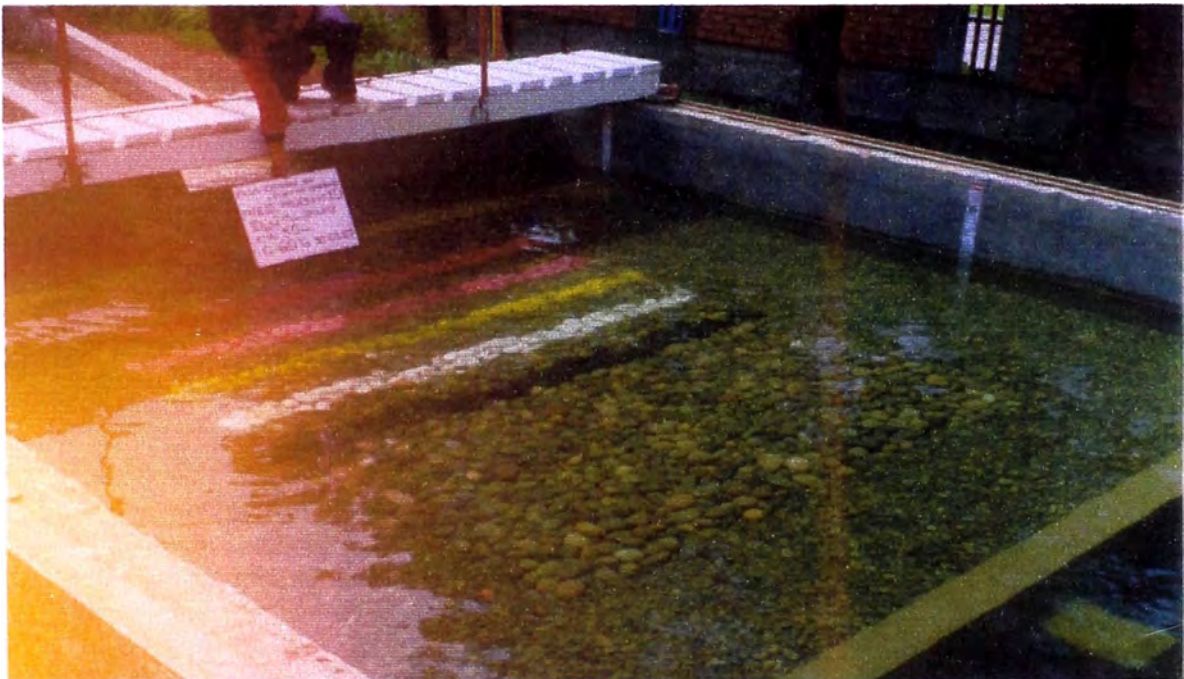
Fotografía N° 41: Fase III-Prueba 10:( Q = 0.06 \text{ m}^3/\text{s} , h_{CA} = 0.50 \text{ m} , d_{50} = 49.08 \text{ mm} ). Vista del cuenco después de dos horas de prueba. No se produjo erosión.
