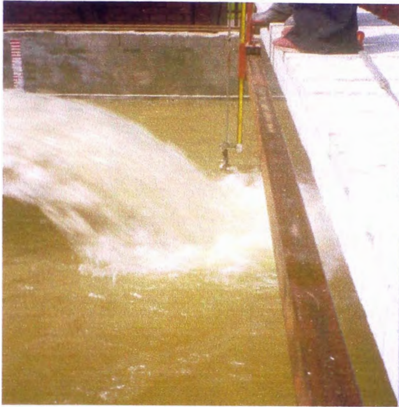
Fotografía N° 16: Fase I - Prueba 11. ( Q = 0.06 \text{ m}^3/\text{s} , h_{CA} = 0.25 \text{ m} , d_{50} = 1.60 \text{ mm} ) Vista de la toma de velocidad en la zona de impacto (sección 0+120 y en -0.60 cm del eje).
