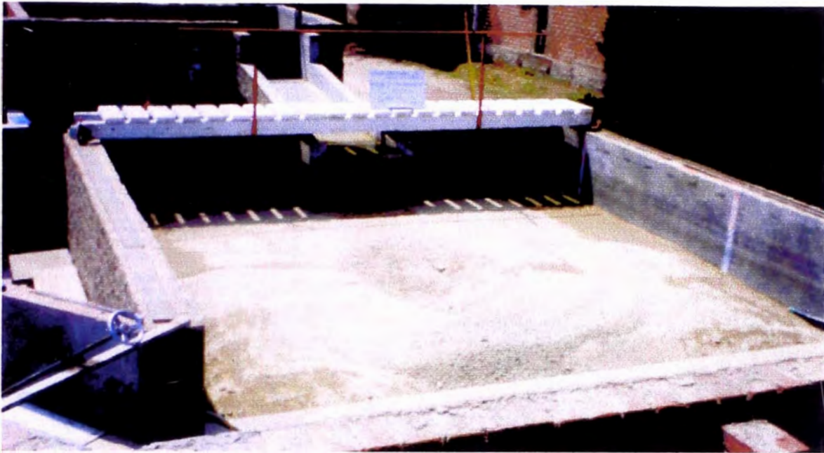
Fotografía N° 09: Fase I - Prueba 7. ( Q = 0.04 \text{ m}^3/\text{s} , h_{CA} = 0.25 \text{ m} , d_{50} = 1.60 \text{ mm} ) La profundidad de erosión en esta prueba, después de dos horas de prueba, fue de 0.245 m.
