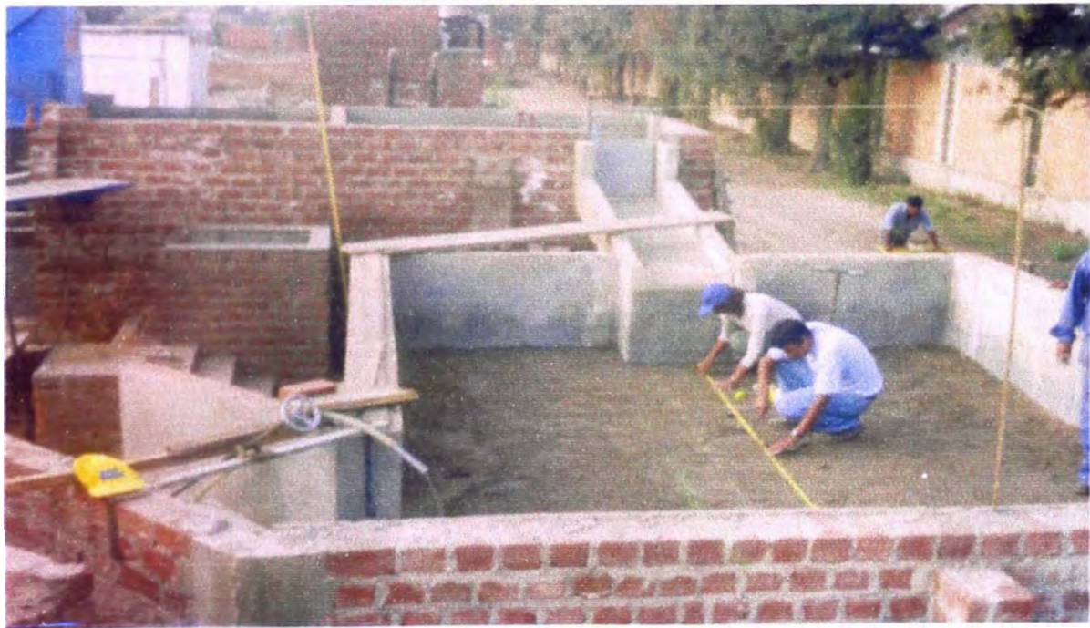
Fotografía N° 02: Fase I - Colocación de las bolas de color en tres ejes paralelos a la rápida.
