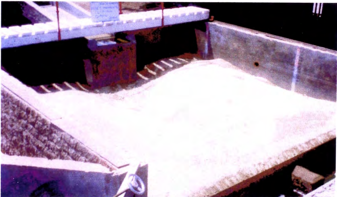
Fotografía N° 08: Fase I - Prueba 5. ( Q = 0.04 \text{ m}^3/\text{s} ; h_{CA} 0.05 \text{ m} ; d_{50} = 1.60 \text{ mm} ) Se observa la poza de erosión después de dos horas de prueba. La profundidad de erosión fue de 0.309 \text{ m} . De modo similar fue para la Prueba 6, siendo la profundidad de erosión de 0.301 \text{ m}
