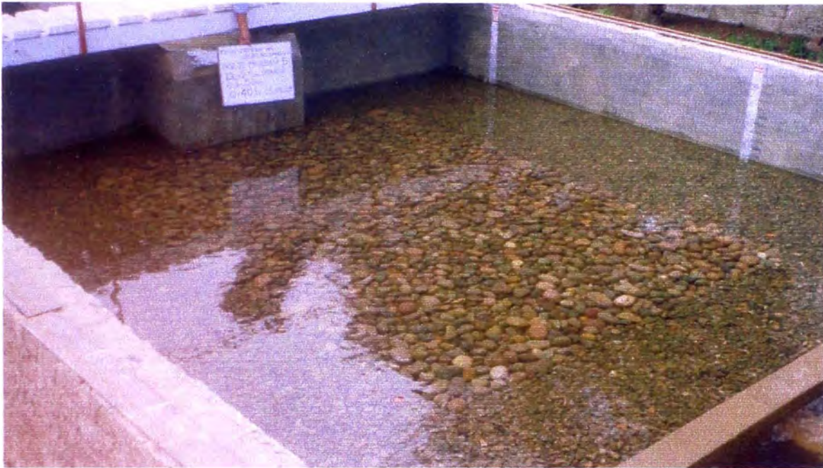
Fotografía N° 36: Fase III-Prueba 5: ( Q = 0.04 \text{ m}^3/\text{s} , h_{CA} = 0.50 \text{ m} , d_{50} = 49.08 \text{ mm} ). Vista del cuenco después de dos horas de prueba. No se produjo erosión.
