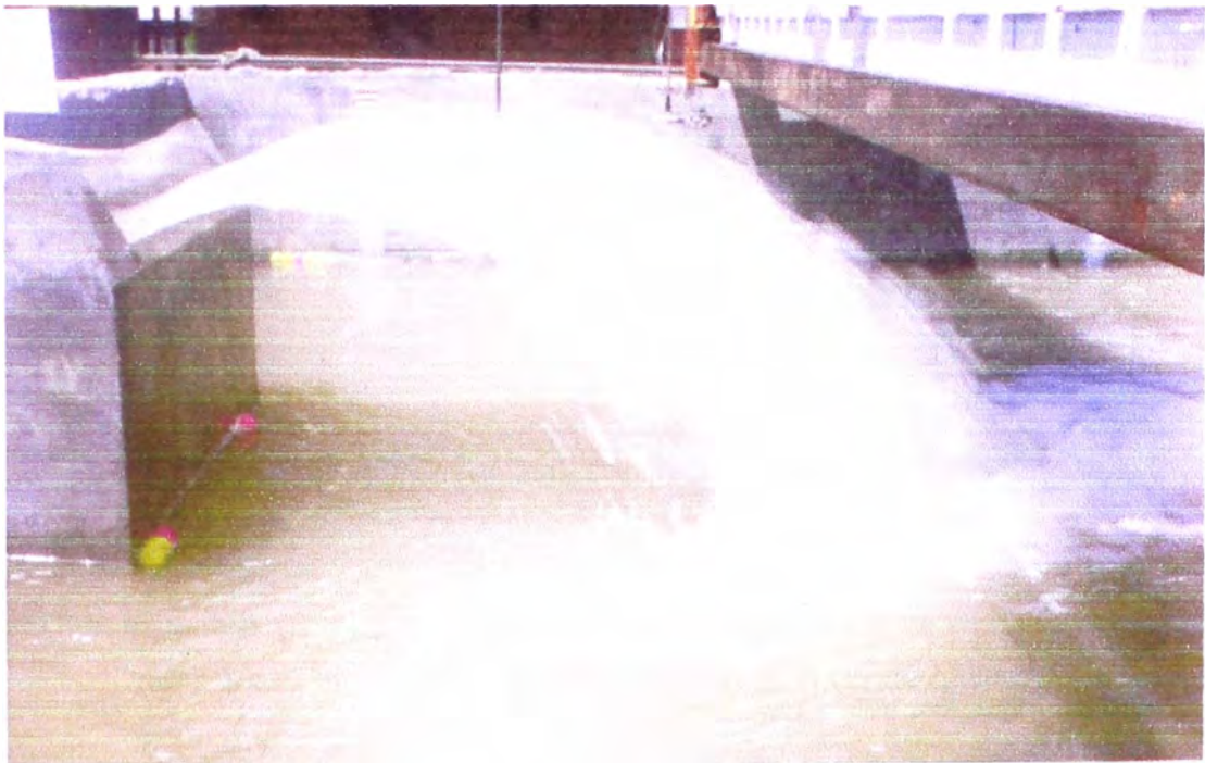
Figura 3.4: Prueba 9. ( Q = 0,06 \text{ m}^3/\text{s} , h_{CA} = 0,10 \text{ m} , d_{50} = 1,60\text{mm} y d_{85} = 4,81\text{mm} ). Se observa las bolas rosadas y amarillas señal de que la erosión supero los 20 cm de profundidad del lecho.
