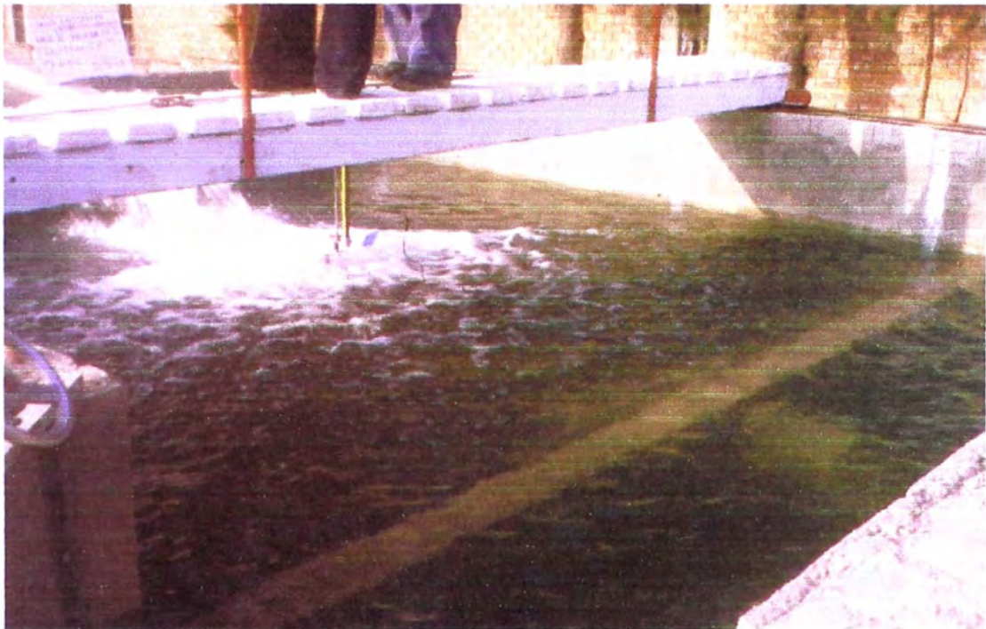
Foto 3.5: Prueba 5. ( Q = 0,04 \text{ m}^3/\text{s} , h_{CA} = 0,05 \text{ m} , d_{50} = 17,88 \text{ mm} y d_{85} = 23,43 \text{ mm} ). Vista de la toma de velocidad en la zona de impacto (en el eje).
