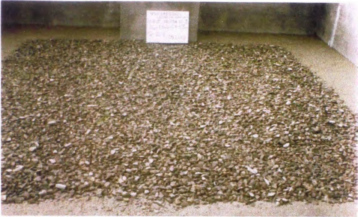
Fotografía N° 23: Fase II - Prueba 3 y 4 : ( Q = 0.02 \text{ m}^3/\text{s} , h_{CA} = 0.25 \text{ m} y 0.50 \text{ m} , d_{50} = 17.88 \text{ mm} ). Vista de la poza de erosión, después de dos horas de prueba. No hubo proceso de erosión.
