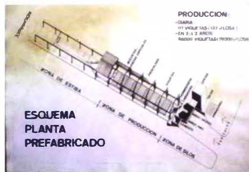
Figura 5. Esquema de la planta de prefabricación. Complejo José P. Varela.
