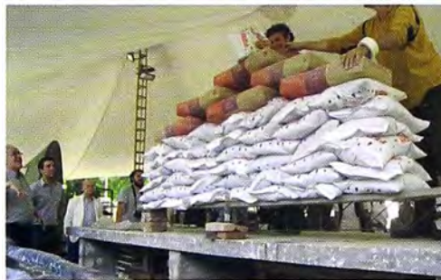
Figura 16. Prueba de carga de la loseta nervada. Sistema Consur 2.
