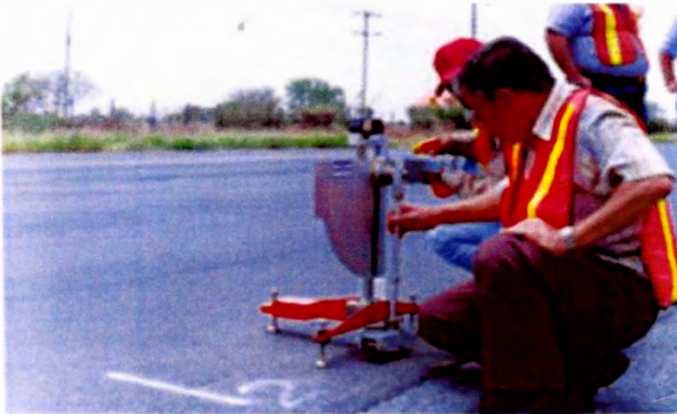
Foto 4. - Péndulo con el brazo oscilante libre para calibración del cero.
