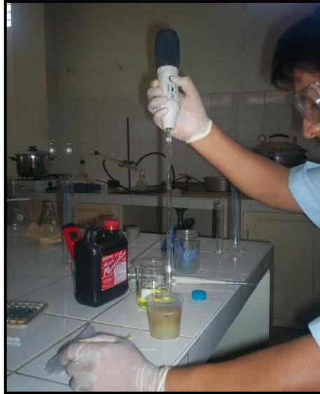
IMAGEN 25- Ensayo de laboratorio de Neutralización de una muestra de las aguas servidas del lavado de vísceras.
