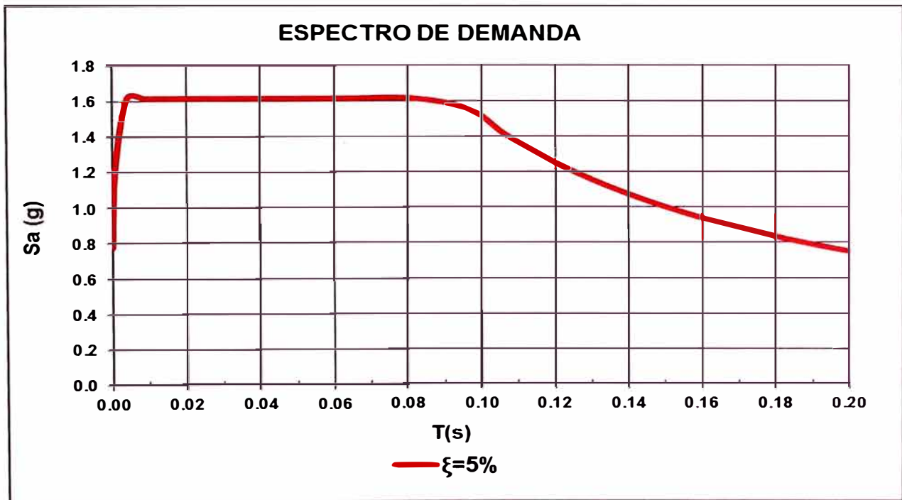
Figura 98.-Espectro de demanda para un periodo de retorno de 2500 años Fuente: Elaboración propia.
