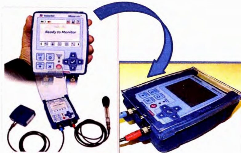
Figura 60.-Equipo Micromate System (ISEE) de Monitoreo Avanzado de Vibraciones y de Sobrepresión y Geófono Triaxial Estándar Instantel (versión ISEE o DIN)
