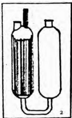
En el cuerpo de este brazo, se encuentra un cuello angosto que lleva un tapón de jebe y sirve para la colocación de los tubos de vidrio y para la limpieza. Los tapones de jebe, deberán estar completamente cerrados para evitar escapes de gases. Todas las pipetas en el cuerpo central y en uno de los bulbos, lleva un tubo que sirve para el ingreso de los gases. Estos tubos van conectados al ramal central de llaves de comunicación, por medio de un pedazo de manguera de jebe, Fig. No. 2.
