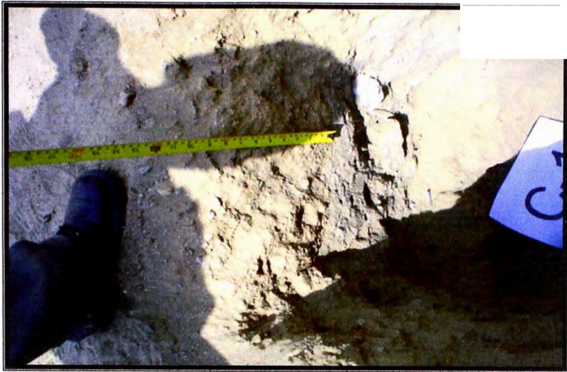
FOTO N° 09. -Se puede apreciar el espesor que presenta el primer estrato, siendo este de granulometría fina y color amarillento.
