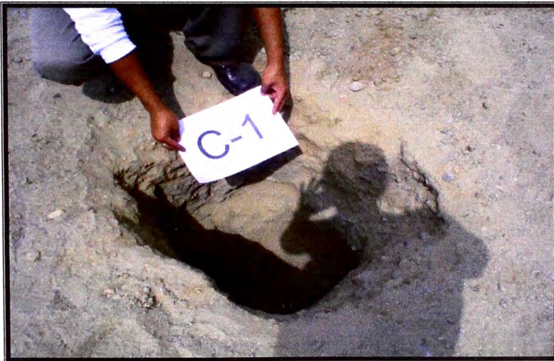
FOTO N° 08. -Registro fotográfico de la calicata realizada en el Km. 64 + 122, la profundidad de excavación fue de 1.50 m a cielo abierto.
