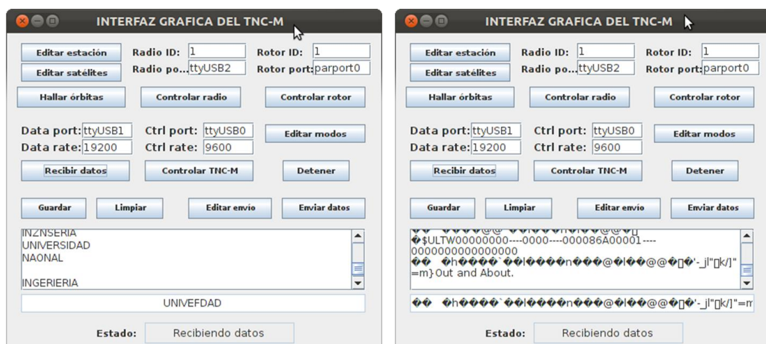
Figura 7.23: Prueba de decodificación automática de dos modulaciones
