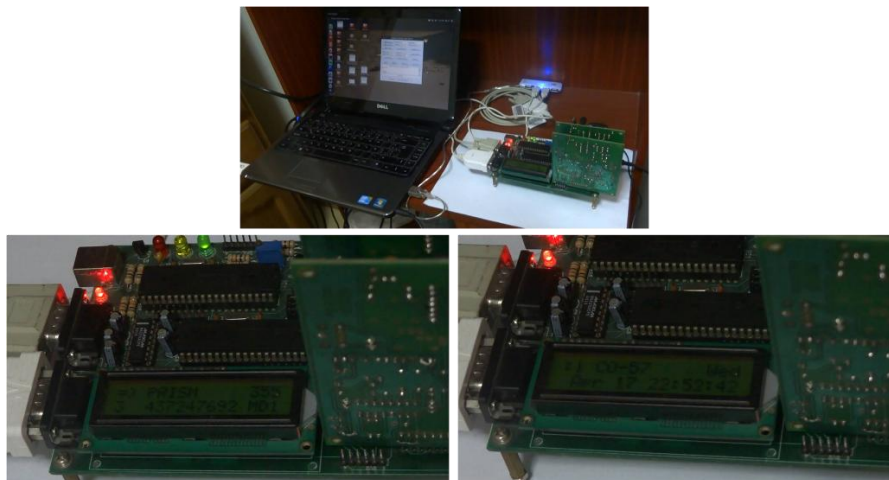
Figura 7.22: Prueba de algoritmo de control del TNC multimodulación
