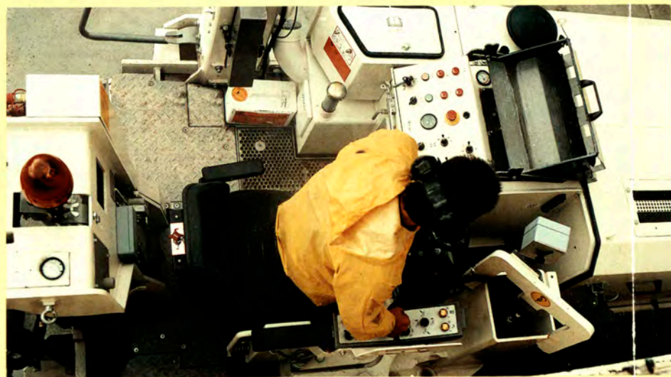
El puesto de mando de la máquina W 1000 L visto desde arriba: Los principales elementos están integrados en el apoyabrazos del asiento, los restantes se encuentran a mano.
