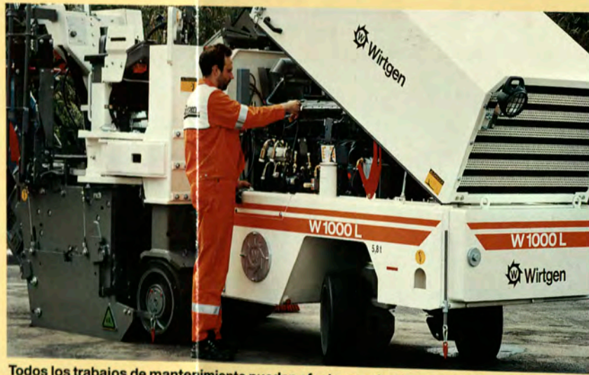
Todos los trabajos de mantenimiento pueden efectuarse desde un solo lado, y el capó, que se abre en un amplio ángulo, posibilita una buena accesibilidad.
