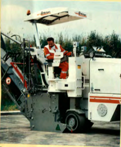
La rueda trasera derecha puede replegarse con unos pocos movimientos.
