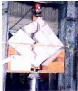
Ensayo de compresión axial en pilas (izq.) y de compresión diagonal en muretes (der).
