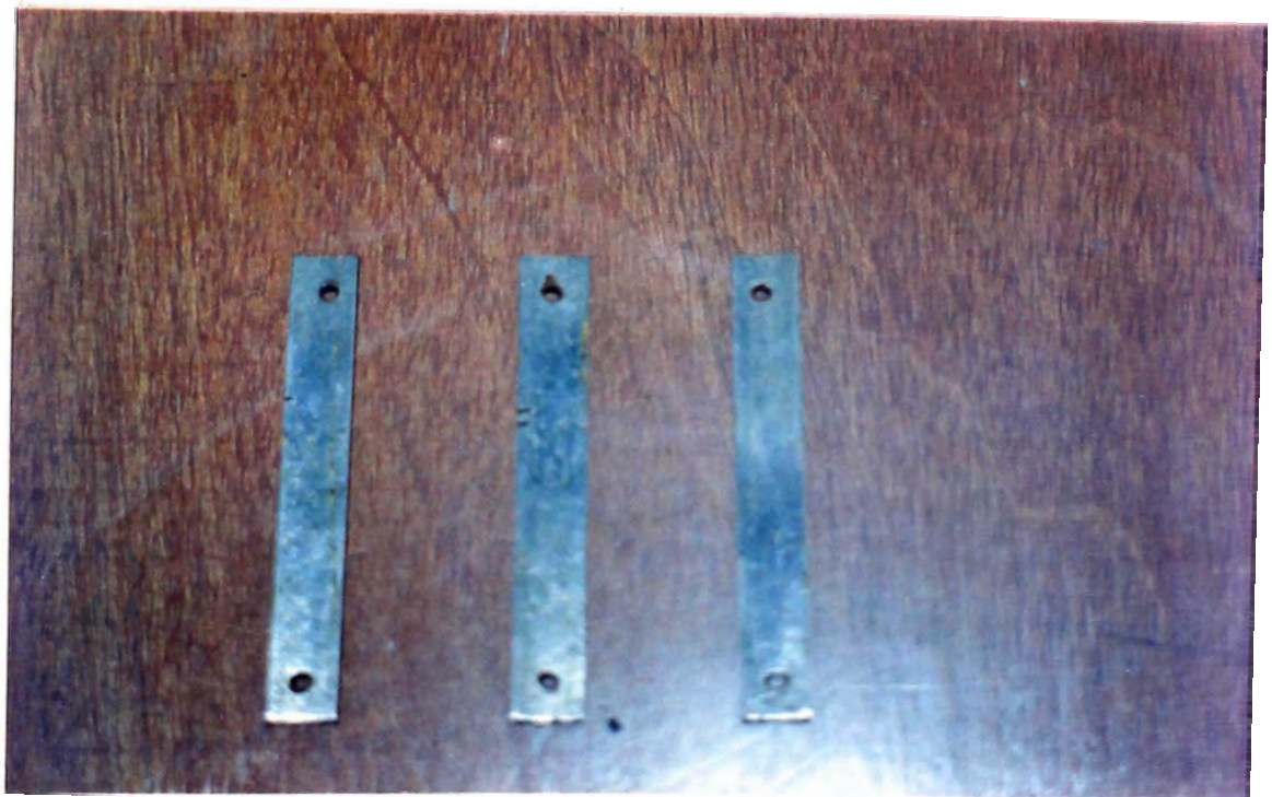
Pretratamiento de los cupones de corrosión
