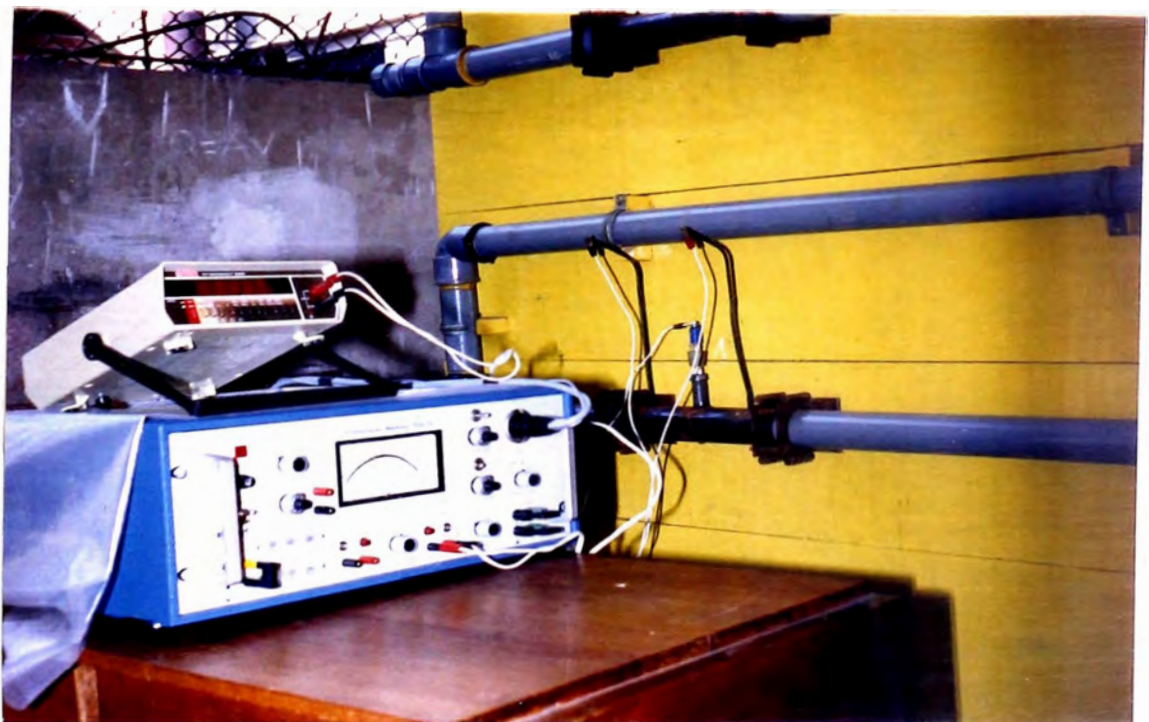
Conexión del Potenciostato con la celda de corrosión
