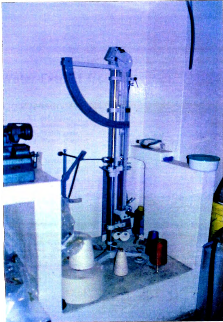
FIG.12.- TENSIOMETRO: MIDE RESISTENCIA DEL HILO.
